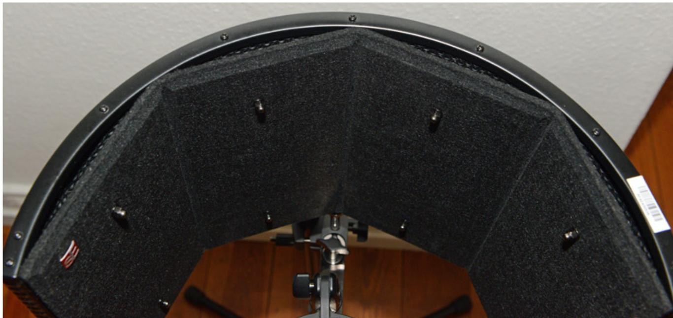
Das Filter besteht aus einem gelochten Metallsegment mit verschiedenen Schichten von Dämmmaterial im Segment befinden sich zusätzlich vier mit Gewindestangen montierte Akustikplatten. Durch das Multilayer-Prinzip wird erreicht, dass die Dämpfung der Reflexionen klangneutral ausfällt.
