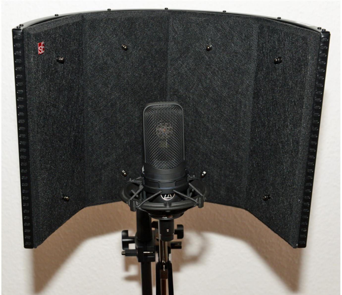
Zunächst einmal ein Überblick was das Reflexion Filter eigentlich leistet. Bei korrekter Anwendung schirmt das Reflexion Filter das Mikrofon von akustischen Reflexionen durch die Raumwände ab. Das ist seine primäre Funktion. Optimal ist die Position der Mikrofonkapsel in der Mitte des Filters.
