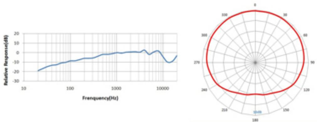
Man sieht deutlich die abfallende Kurve zu den tieferen Frequenzen hin, was eine gute Unterdrückung von Handhabungsgeräuschen u. a. tieffrequenten Störungen gewährleistet.
