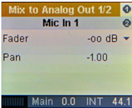
Die Eingangssignale lassen sich auch über die Mix-Taste direkt auf die analogen Ausgänge legen.
