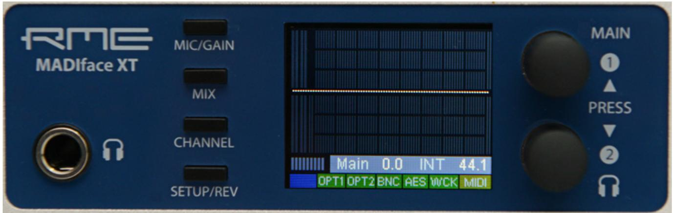
Die Bedienung erfolgt per Software - dazu später mehr - oder eben an der Geräte-Front über vier Tasten und die beiden Drehgeber.
