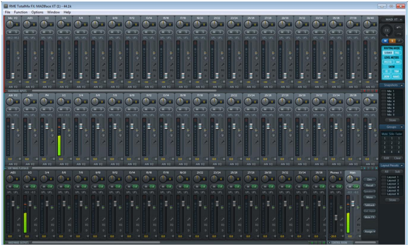
Der eigentliche Clou des MADifaces sind nicht die drei MADI-I/Os sondern, dass man jeden Kanal im Pegel über den Mixer beeinflussen und über die Matrix routen kann. Gerade bei MADiface XT sind die Möglichkeiten so enorm. Es lassen sich bis zu 99 Stereo-Submixes anlegen.
