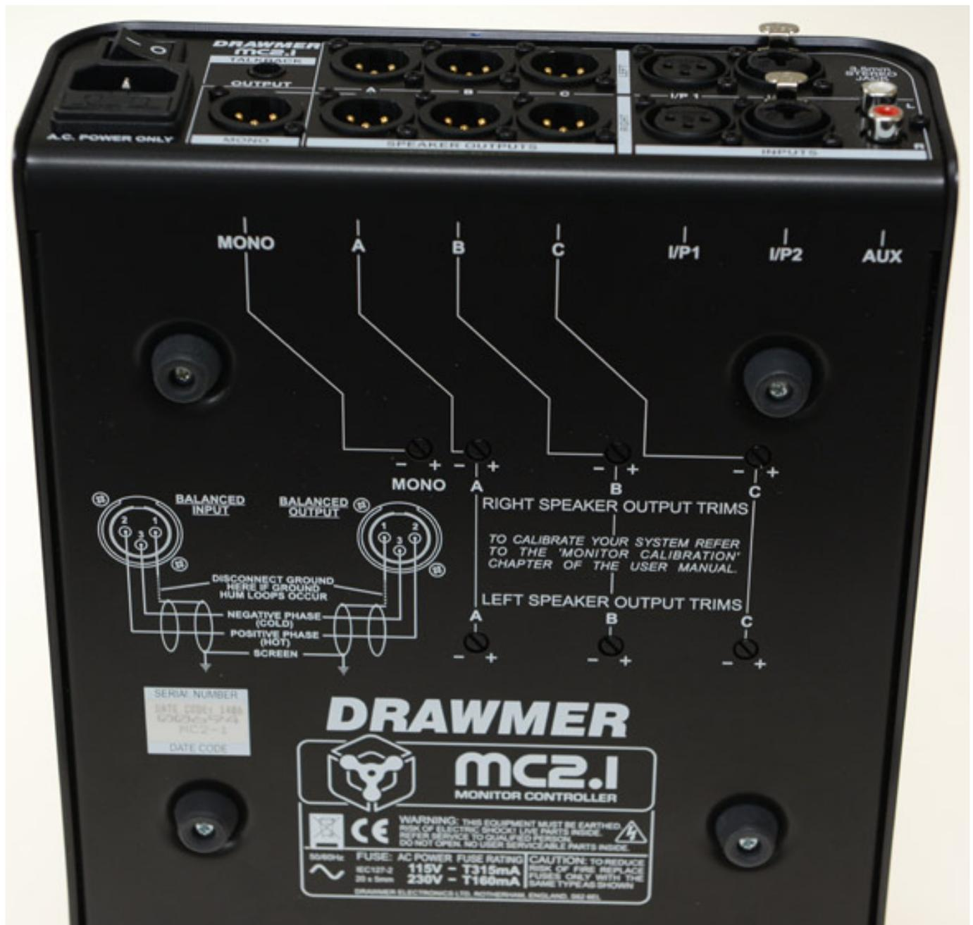
Dem stehen drei Monitor-Ausgänge gegenüber, Die als SPEAKER OUTPUTS bezeichnet sind und zum Anschluss an Leistungsverstärker oder aktiven Boxen gedacht sind. Natürlich lassen sich hier auch andere Senken anschließen, wie z. B. ein zusätzlicher Kopfhörerverstärker etc. Ein weiterer Ausgang ist ein Mono/Ausgang, an dem z. B. ein Subwoofer angeschlossen werden kann. Der maximale Ausgangspegel beträgt übrigens 27 dBu.
