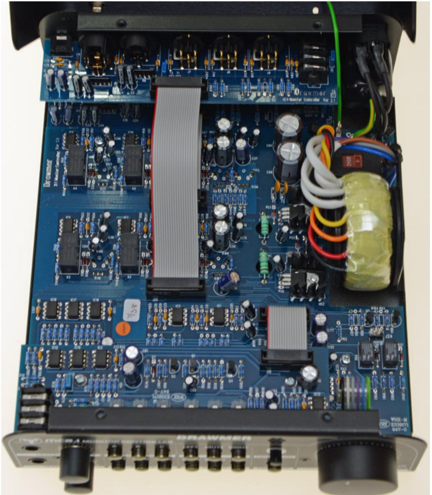
Natürlich lassen wir uns es nicht nehmen, auch ein Blick in das Geräteinnere zu werfen. Es kommen rauscharme OPAMPS zum Einsatz und einige Signale werden mit Relais geschaltet. Der Aufbau ist insgesamt sehr sauber gestaltet. Der Umschalter für die Netzspannung befindet sich übrigens auf dem Foto über dem
