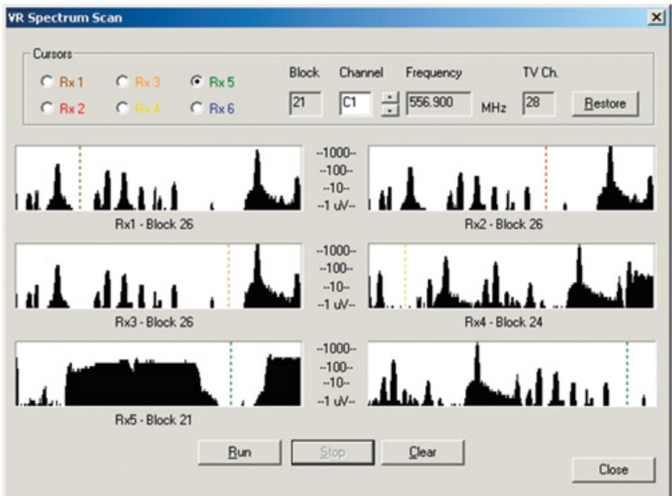
Es lässt sich auch ein Scan mit den eingesetzten Empfängermodule durchführen (s. Abb. oben).
