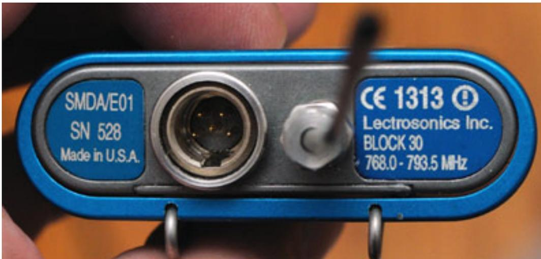
Die Antenne ist abnehmbar und der HF-Ausgang verfügt über einen speziellen Ausgangstransformator und ist so galvanisch getrennt und verhindert auch, dass HF-Signale zurück auf die Senderausgangsstufe gelangen. Auf wird durch den Übertrager die Ausgangsstufe unempfindlich gegen elektrostatische Aufladung.
