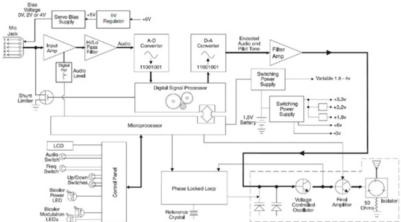
Es stehen 256 Frequenzen im 100 kHz Raster zur Verfügung. Die Sendeleistung beträgt 50 mW. Der SMB/E01 (Bild unten) ist ein Sender mit einer AA-Batterie. Mit einer handelsüblichen Batterie lässt sich der Sender zwei Stunden betreiben und mit einer 2.500 mAh NiMH-Akku bis zu fünf Stunden.
