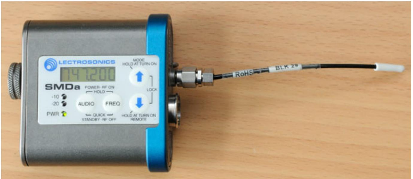
Auf der Stirnseite befindet sich eine TA5-Buchse mit Spannungsversorgung für Elektret-Mikrofone. Die Eingangsstufe verfügt über einen analogen Limiter, der vom DSP kontrolliert wird. Weiter lässt sich auch ein Hochpassfilter mit schaltbarer Grenzfrequenz (35, 50, 70, 100, 120 und 150 Hz) zuschalten.
