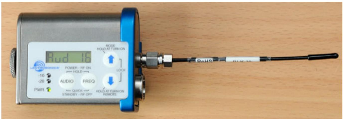
Der Taschensender SMDB/E01 wird mit zwei AA-Zellen betrieben und ist technisch sonst baugleich. Wir hatten die a-Versionen im Test und daher auch hier auf den Fotos. Größe und Bedienung ist aber absolut identisch. Die Betriebszeit des SMDB/E01 beträgt mit einer Batterie sechs Stunden und mit 2.500 mAh NiMH-Akku ca. 8,5 Stunden.
