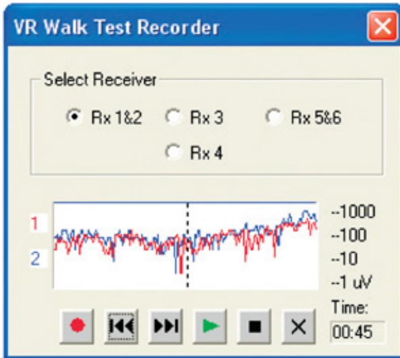
Interessant ist auch ein in die Software integrierter Walk Test Recorder, z. B. zum Überprüfen der Ausleuchtung kritischer Bereiche.
