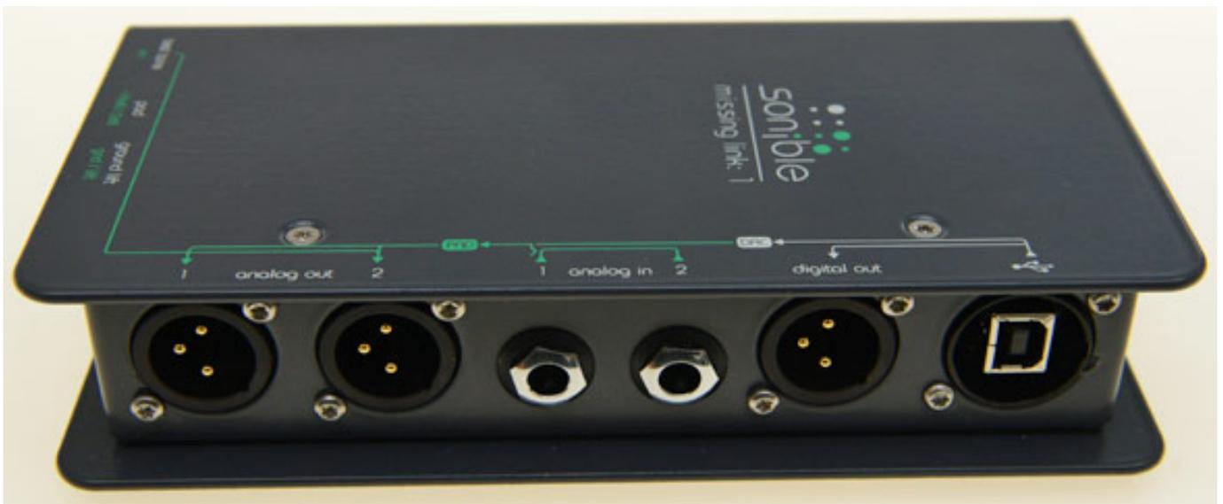
Das ml:1 verfügt über zwei 6,3-mm-Stereo-Klinkenbuchsen für das Zuführen eines unsymmetrischen Line-Pegel-Instrumentensignals und zwar für jeden Kanal eine Buchse. Das Signal wird dann an zwei XLR-3-Buchsen (verriegelbar) Übertragersymmetrisch ausgegeben. Der Testtongenerator gibt sein Signal bei Aktivierung ebenfalls auf den XLR-Buchsen aus.
