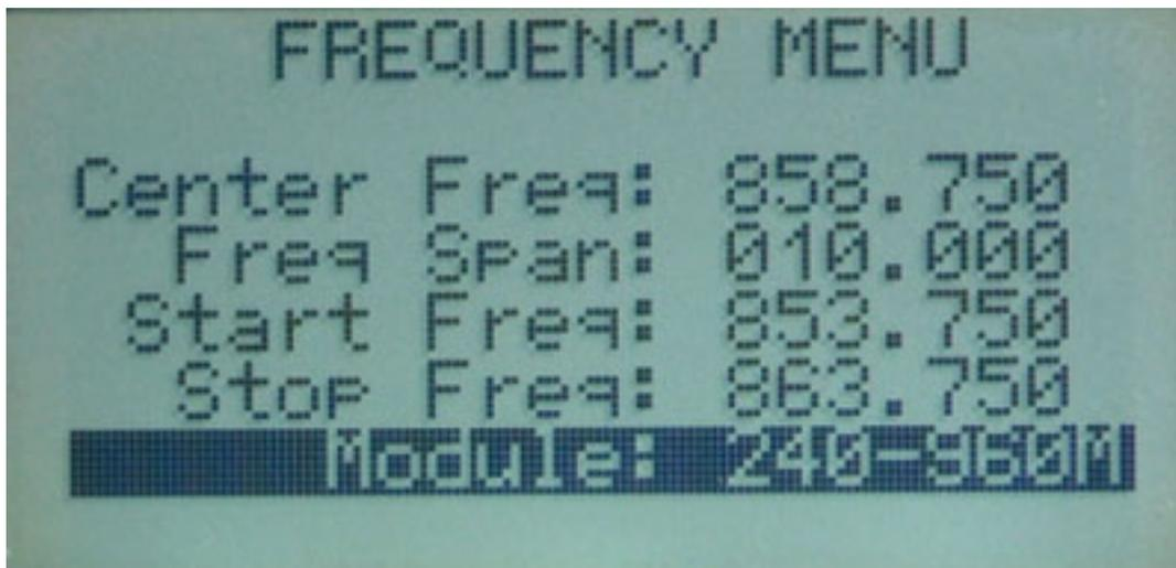
Wählt man die Betriebsart Spectrum Analyzer, so werden über das nächsten Menü der zu überwachende Frequenzbereich definiert. Das kann entweder über Eingabe von Mittenfrequenz und Bandbreite oder über die Eingabe von Start- und Endfrequenz geschehen. Der dargestellte Frequenzbereich hat dabei eine maximale Bandbreite von 100 MHz.
