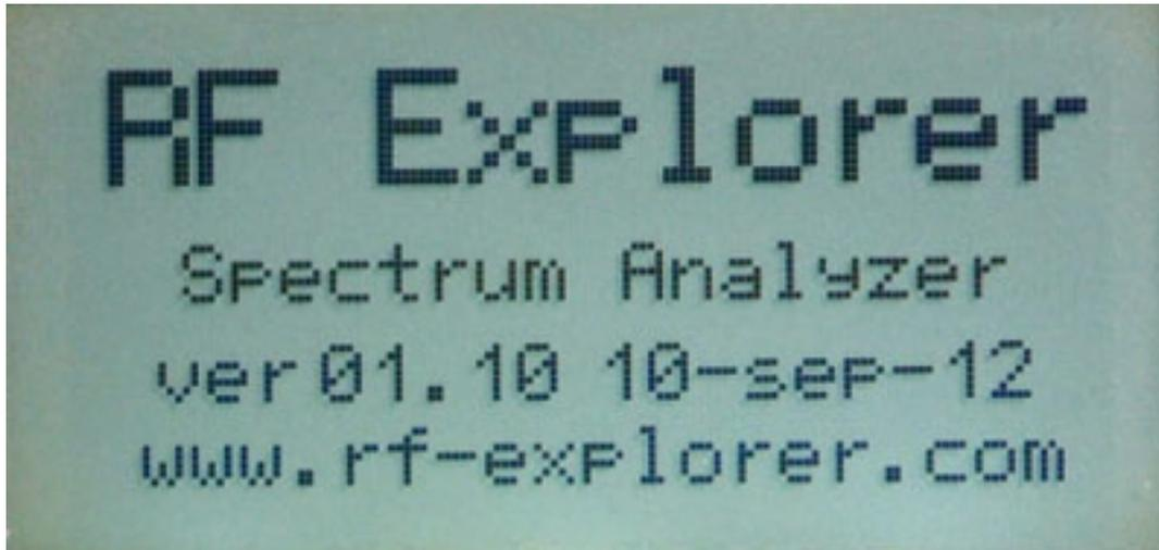
Nach dem Einschalten meldet sich das Gerät mit der Ausgabe der Firmware-Version. Das LC-Display ist hintergrundbeleuchtet und hat eine Auflösung von 128 x 64 Pixel.
