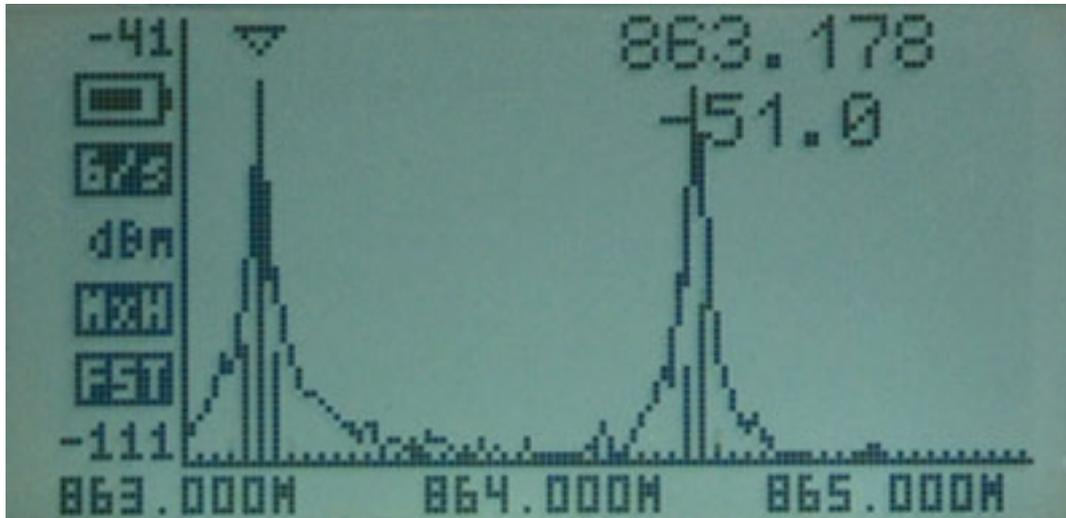
Die Ensembles eines DVB-T-Senders sind schnell lokalisiert (s. Abb. unten) oder andere mögliche Interferenzquellen schnell ausgemacht.
