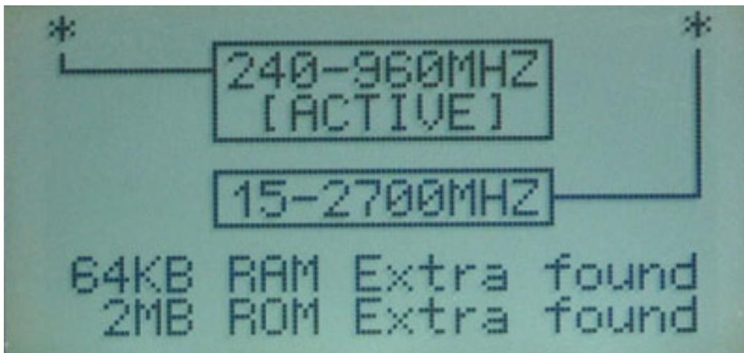
Dann wird kurz angezeigt, welches der beiden Empfangsmodul, bzw. welcher Antenneneingang, aktiv geschaltet ist.
