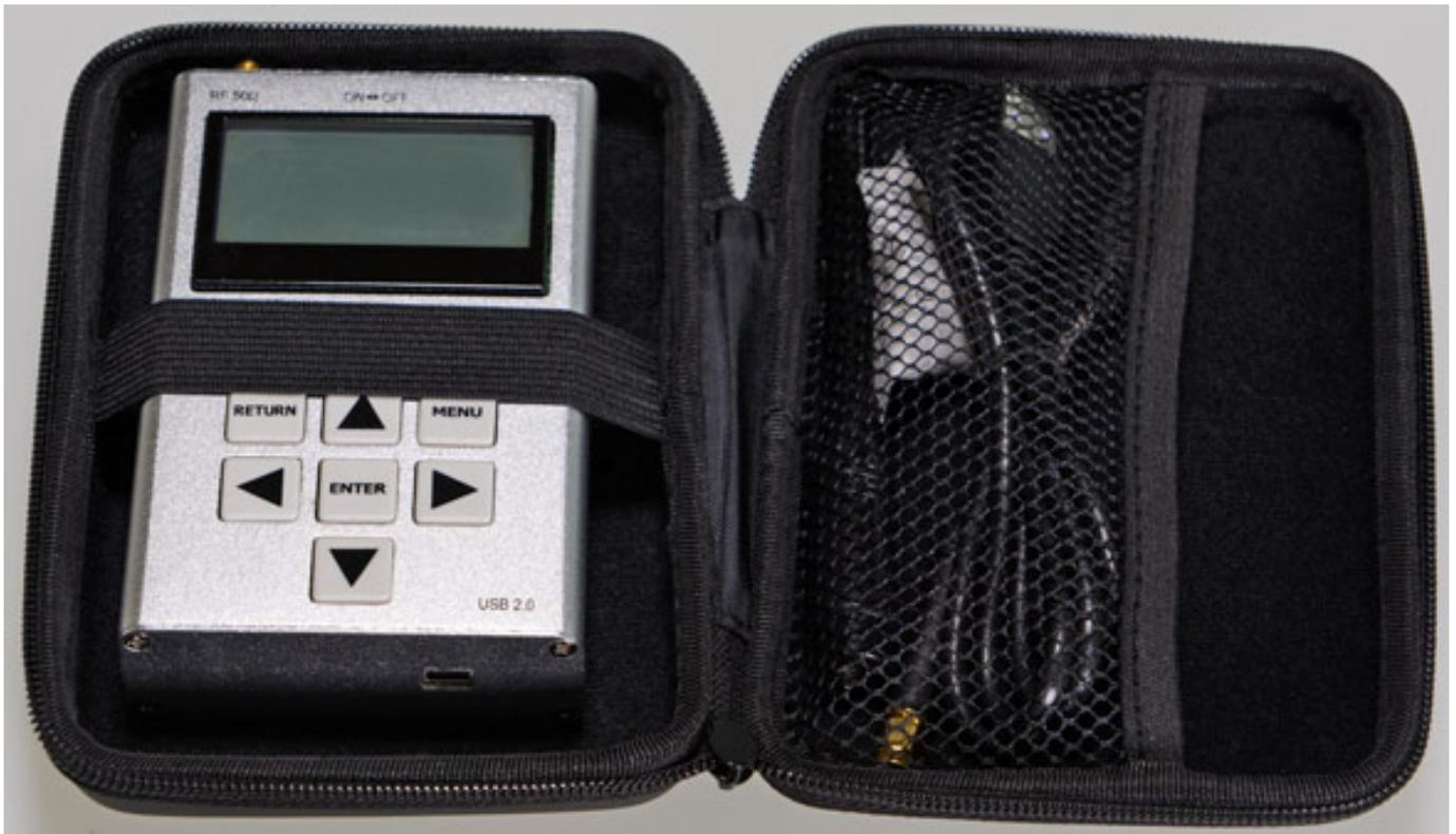
Geliefert wird der der RF-Explorer/3 in einer Transporttasche. Mitgeliefert werden neben einem USB-Kabel zwei Antennen und zwar ein Teleskopantenne für den VHF/UHF-Bereich und eine weitere für die höheren Frequenzen. Beide Antenneneingänge sind mit SMA-Buchsen ausgestattet.
