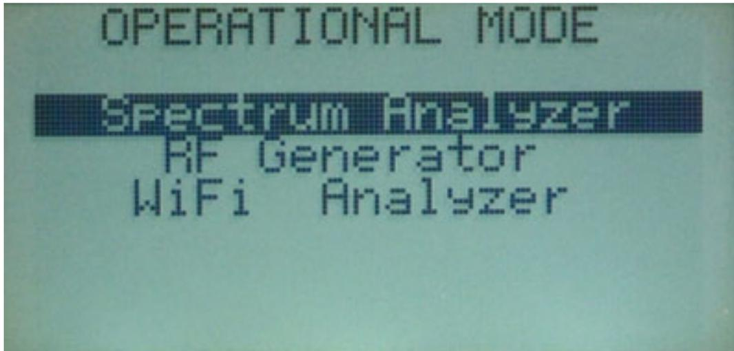
Im ersten Menü legt man die Betriebsart fest (s. Abb. oben). Neben dem Betrieb als Spektrum-Analyzer lässt sich das Gerät auch als WLAN-Kanal-Analyser einsetzen. Es gibt zwar den Eintrag "RF Generator" aber in der Version RF-Explorer/3 steht diese Betriebsart nicht zur Verfügung. Dazu muss man noch ergänzen, dass in den meisten Ländern der Betrieb von Sendern, die nur einen Träger ohne Modulation aussenden, in den Drahtlosfrequenzbereichen sowieso untersagt ist.
