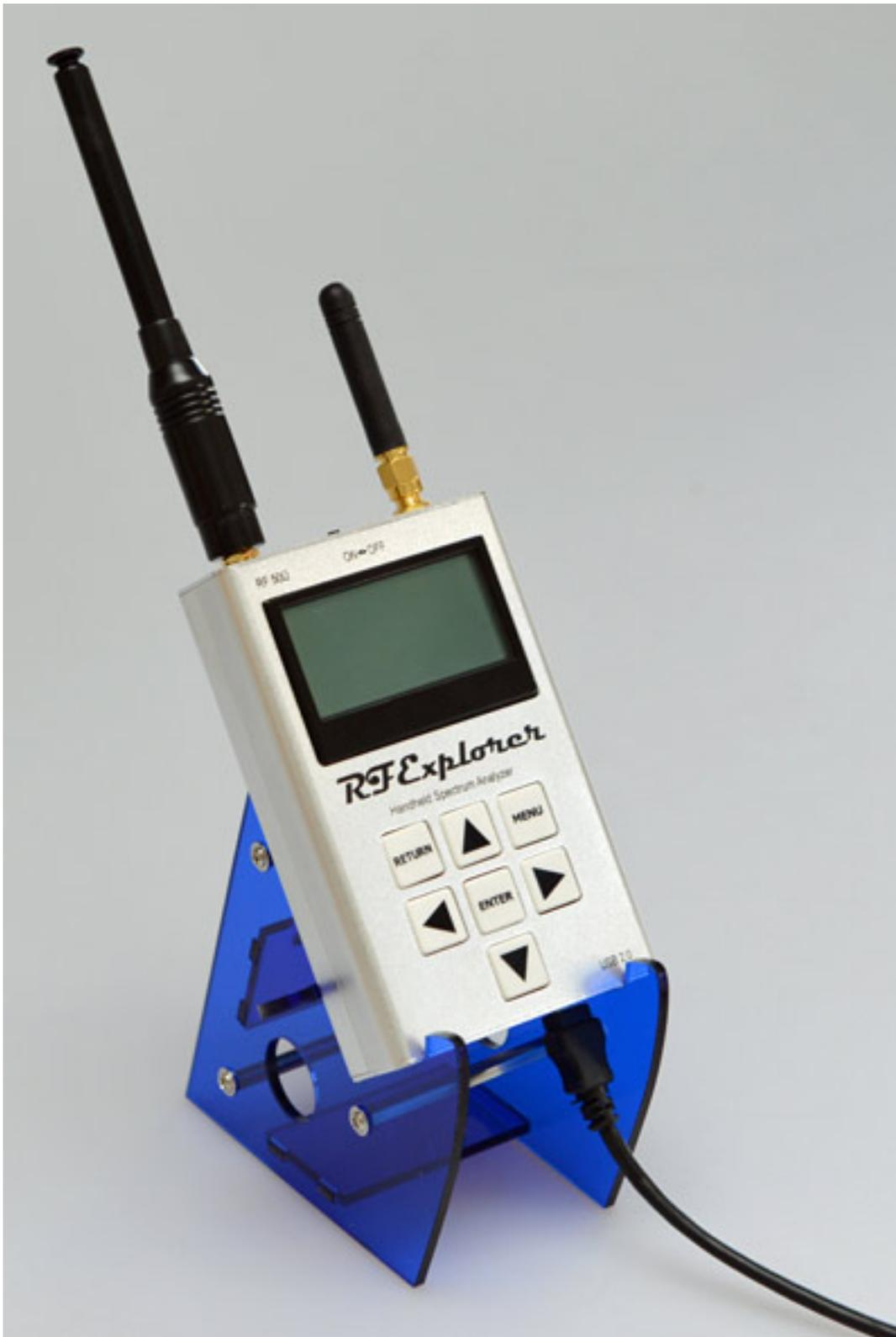
Der RF Explorer ist aber nicht nur ein Handscanner. In Verbindung mit einem PC oder Macintosh-Computer lässt sich das Gerät auch hervorragend für den Festinstallationsbereich nutzen. Zudem ist es so, dass der RF-Explorer/3 bei Anschluss des USB-Kabels aus diesem auch gespeist wird und sich so ohne
