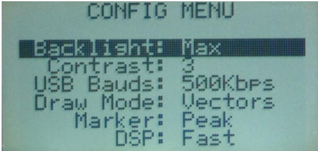
In dem letzten Konfigurationsmenü lassen sich einige Systemparameter wie Stärke der Hintergrundbeleuchtung und Display-Kontrast einstellen. Über den Parameter Draw Mode wird definiert, ob lediglich eine Linien oder ob ein gefüllter Bereich als Grafik ausgegeben wird. Der Parameter DSP ermöglicht einzustellen, ob die Berechnung auf die Ausgabegeschwindigkeit oder die Filterunterdrückung optimiert werden soll.
