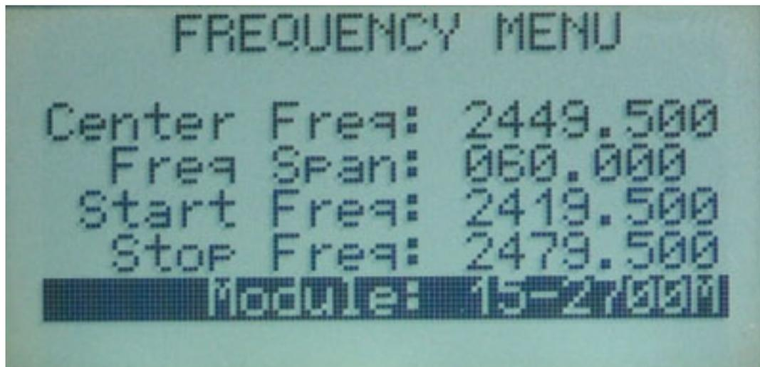
Der unterste Eintrag im FREQUENCY MENU erlaubt die Anwahl eines der beiden Empfangsmodule. Wenn man den WLAN-Modus aktivieren möchte, muss das Modul für den Frequenzbereich 15 bis 2.700 MHz angewählt sein.
