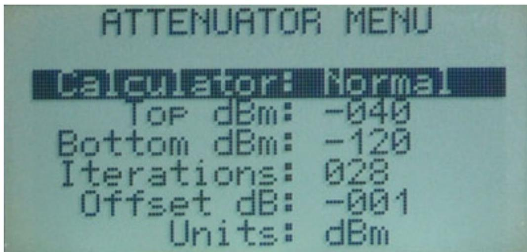
Mit dem nächsten Menü stellt man den darzustellenden Pegelraum ein. Hier lässt sich auch die Einheit für die Empfangsfeldstärke umstellen (dBm oder dBV) sowie die Interpolation für die Grafikausgabe einstellen (Normal, Maximum, Mittelwert, Overwrite, Maximum Hold). Über den Parameter Iterations lässt sich festlegen, wie viele Scann-Durchgänge zur Berechnung der Maximal- oder Mittelwerte herangezogen werden.
