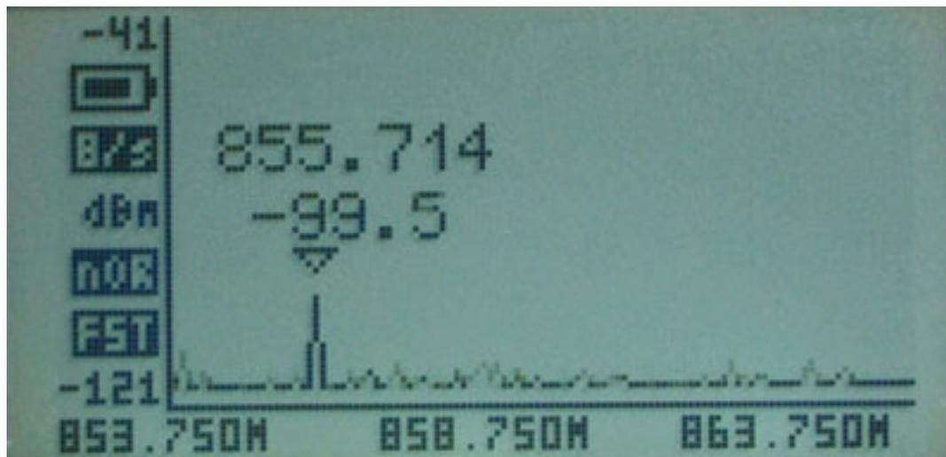
Nach keinen fünf Sekunden ist das Gerät hochgefahren und der konfigurierte Frequenzbereich mit den eingestellten Parametern wird in Form eines Frequenz-Scans auf dem LC-Display ausgegeben. Wenn das Gerät also entsprechend für die eigenen Bedürfnisse vorkonfiguriert ist, kann es schnellstens eingesetzt werden.
