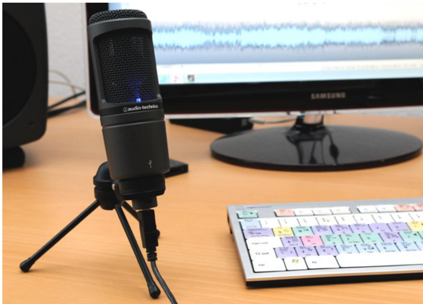
Das AT2020 ist sicherlich eines der preiswertesten Studiomikrofone mit Großmembrane, das in wirklich jedes Budget passt. Das AT2020 gibt es auch in einer Version für den Betrieb an einer USB-Schnittstelle, was wir hier im Detail vorstellen möchten. Kapsel und äußeres des AT2020USB sind mit dem AT2020 identisch. Der einzige, äußere Unterschied ist der USB- statt dem XLR-Anschluss.
