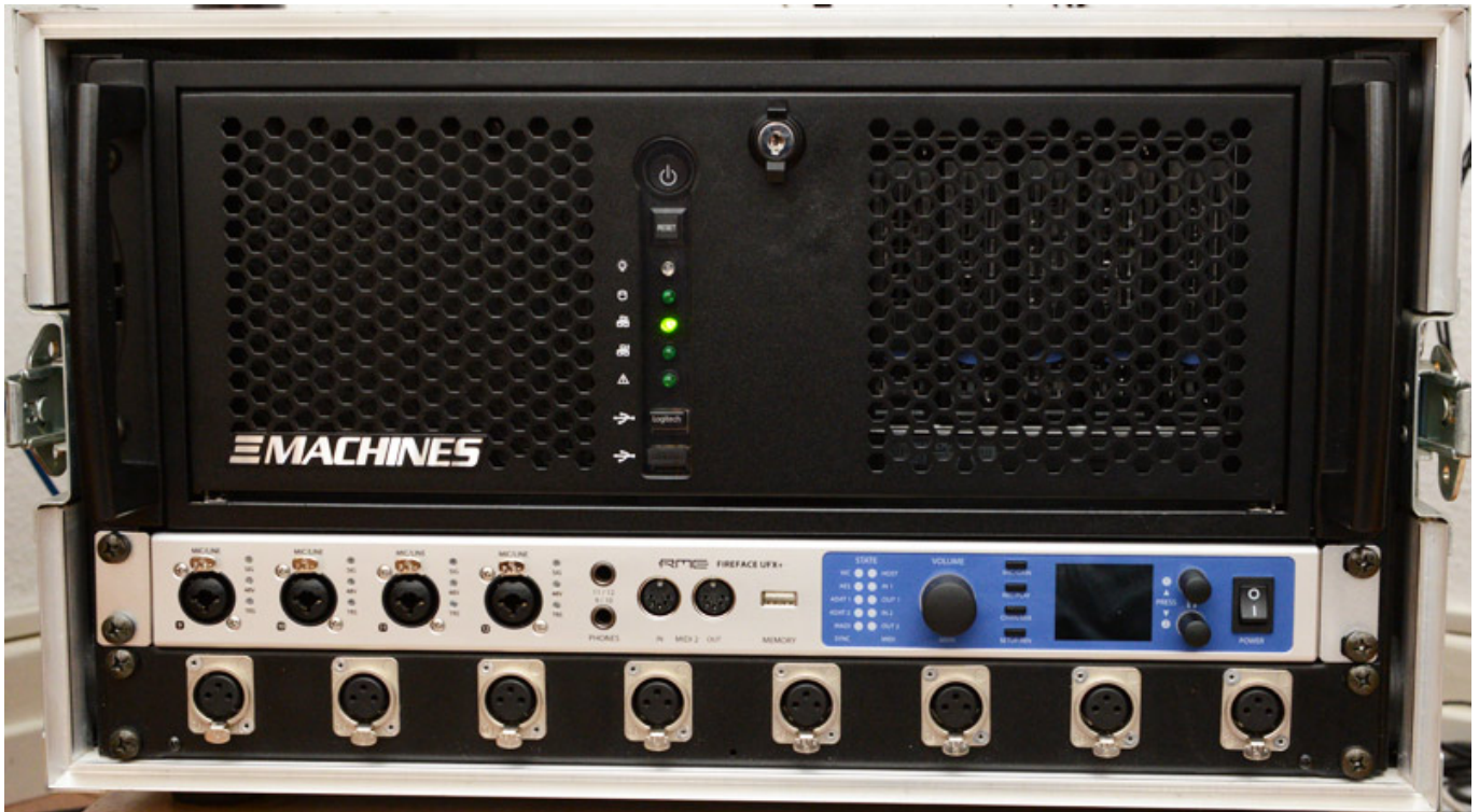
Foto: Testrechner im Rack mit RME UFX+ Audio-Interface und XLR-Eingangsfeld
