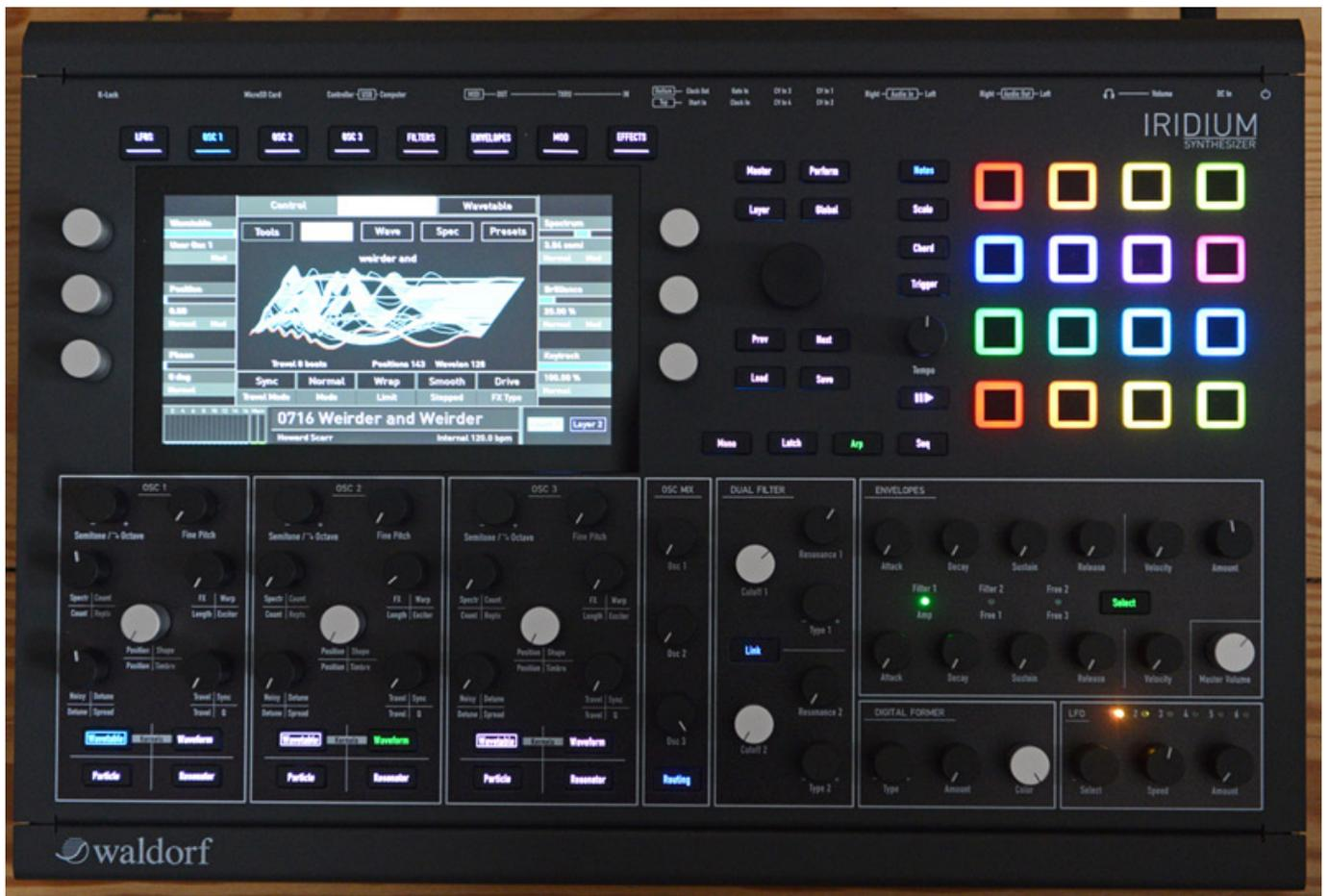
Der Iridium ist vom Layout der Bedienelemente sehr übersichtlich und systematisch aufgebaut. Über dem berührungsempfindlichen Display befinden sich acht Taster zur Auswahl des Display-Modus (LFOs, Oszillator 1/2/3, Filter, Hüllkurven, Modulation, Effekte).
