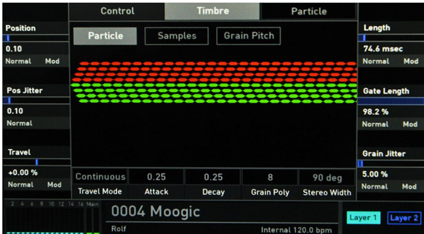
Mit der "Particle" genannten Syntheseart steht auch Granular-Synthese zur Verfügung. Hier gibt es die bekannten Möglichkeiten mit den Grains umzugehen und deren Position und Länge etc. zu verändern (s. Abb. oben).
