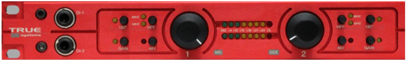
Auf der linken Seite der Frontplatte sind die beiden identischen Sektionen für die Eingangskanäle zu finden. Für jeden Kanal lässt sich individuell Eingangsabschwächung, bzw. zwei Verstärkungsbereiche, die Phasenumkehrung, 48-Volt-Phantomspeisung sowie ein Hochpassfilter, mit einer Grenzfrequenz von 40 oder 80 Hz, zuschalten. Neben den beiden Potis für die Stufenlose Einstellung der Verstärkung ist je ein LED-Bargraf-Aussteuerungsanzeige (8 LEDs) zur Kontrolle des Eingangspegels vorhanden.
