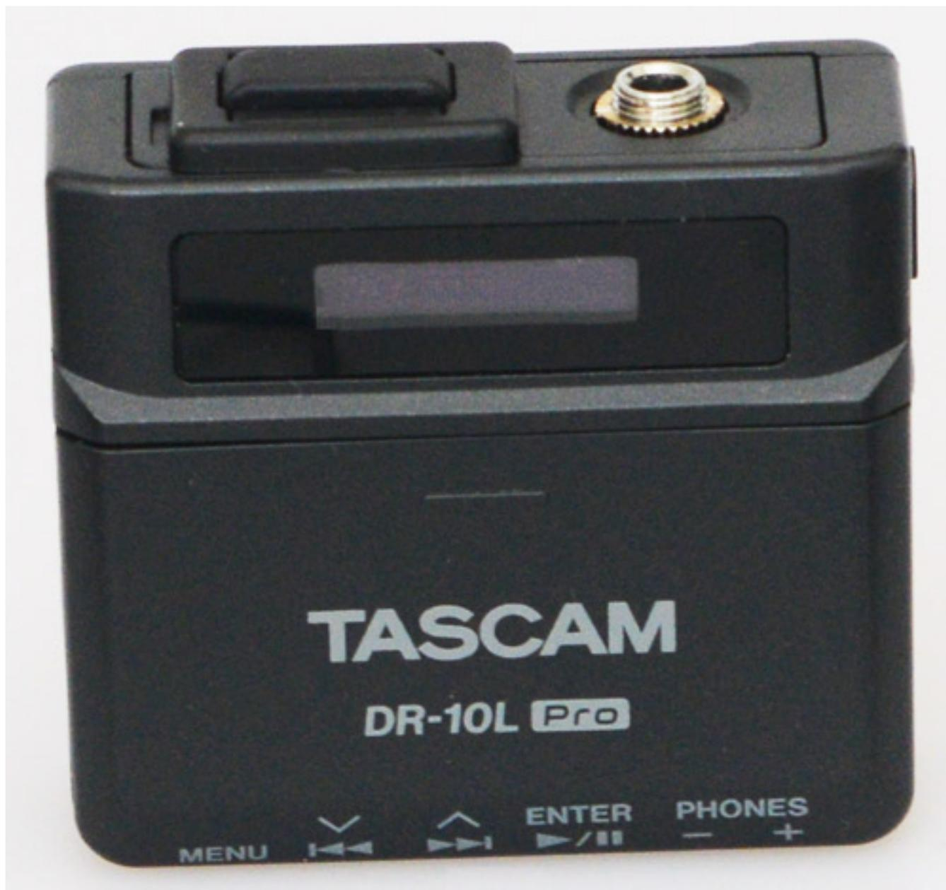
Werfen wir noch einen Blick auf ein paar weitere technische Daten. Der maximale Eingangspegel beträgt -11 dBV und die Anschlussimpedanz  $>2$  Kiloohm. Die einstellbare Eingangsverstärkung beträgt 7,5 bis 38 dB. Der Übertragungsbereich wird mit 20 Hz bis 20 kHz angegeben (0/-1 dB). Der Hersteller nennt einen
