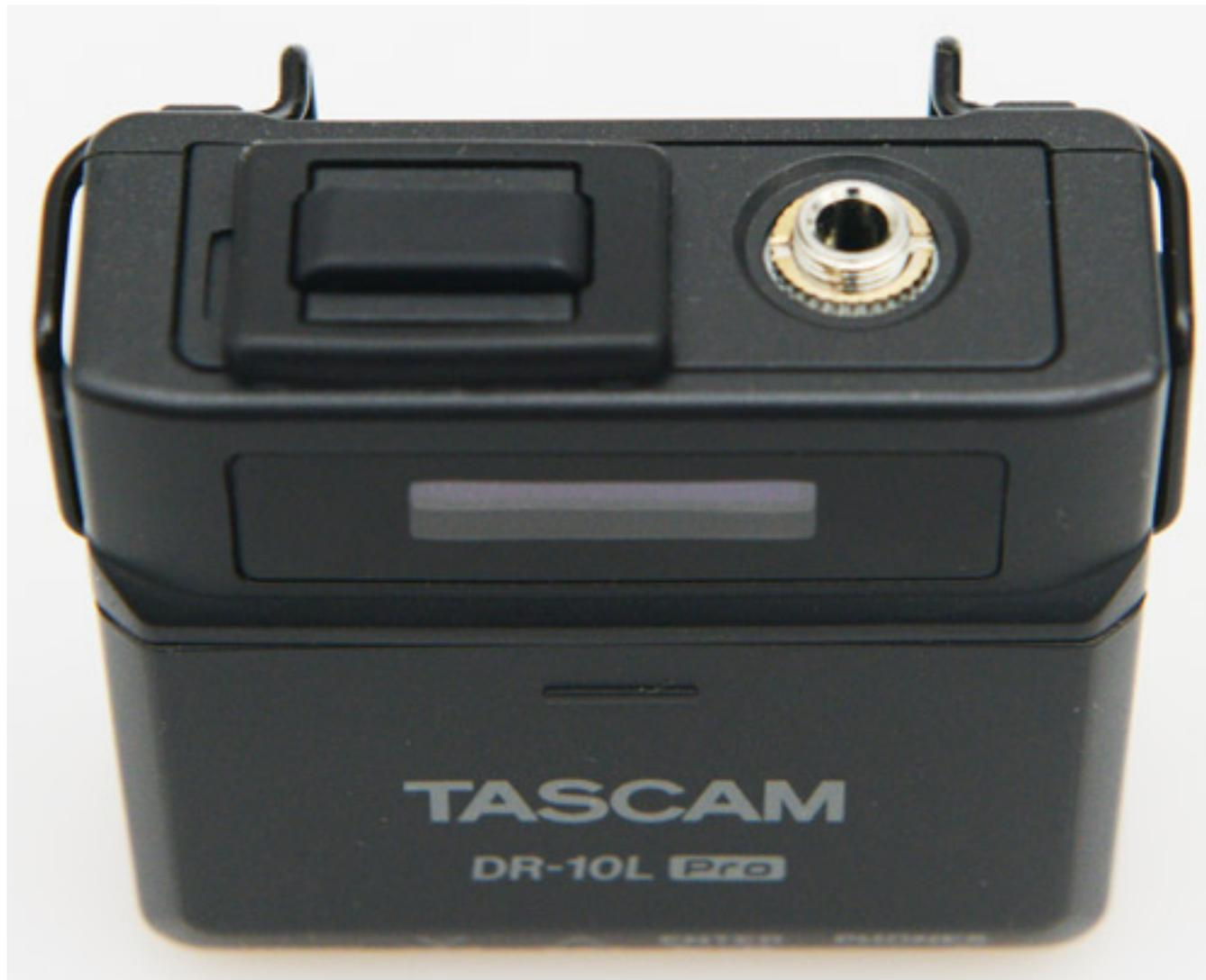
Oben befindet sich eine 3,5-mm-TRS-Klinkenbuchse für den Anschluss von Sennheiser-kompatiblen Mikrofonen. Diese lassen sich auch mit dem Sennheiser üblichen Überwurf am Klinkenstecker arretieren. Auf der Buchse liegt eine 2,3 Volt-Bias-Spannung für das Mikrofon auf.
