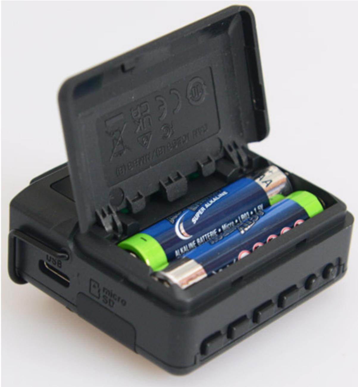
Betrieben wird der DR-10L Pro mit zwei AAA-Batterien. Der Recorder geht extrem sparsam mit der Kapazität um, denn mit zwei Lithium-Batterien sind über 24 Stunden Laufzeit ohne aktiviertem Bluetooth und ohne angeschlossenem Kopfhörer möglich. Mit aktiviertem Bluetooth sind es noch 23 Stunden. Bei Verwendung von normalen Alkaline-Batterien beträgt die Laufzeit bis 16 Stunden mit aktiviertem Bluetooth. Es ist auch eine Spannungsversorgung über USB möglich, aber
