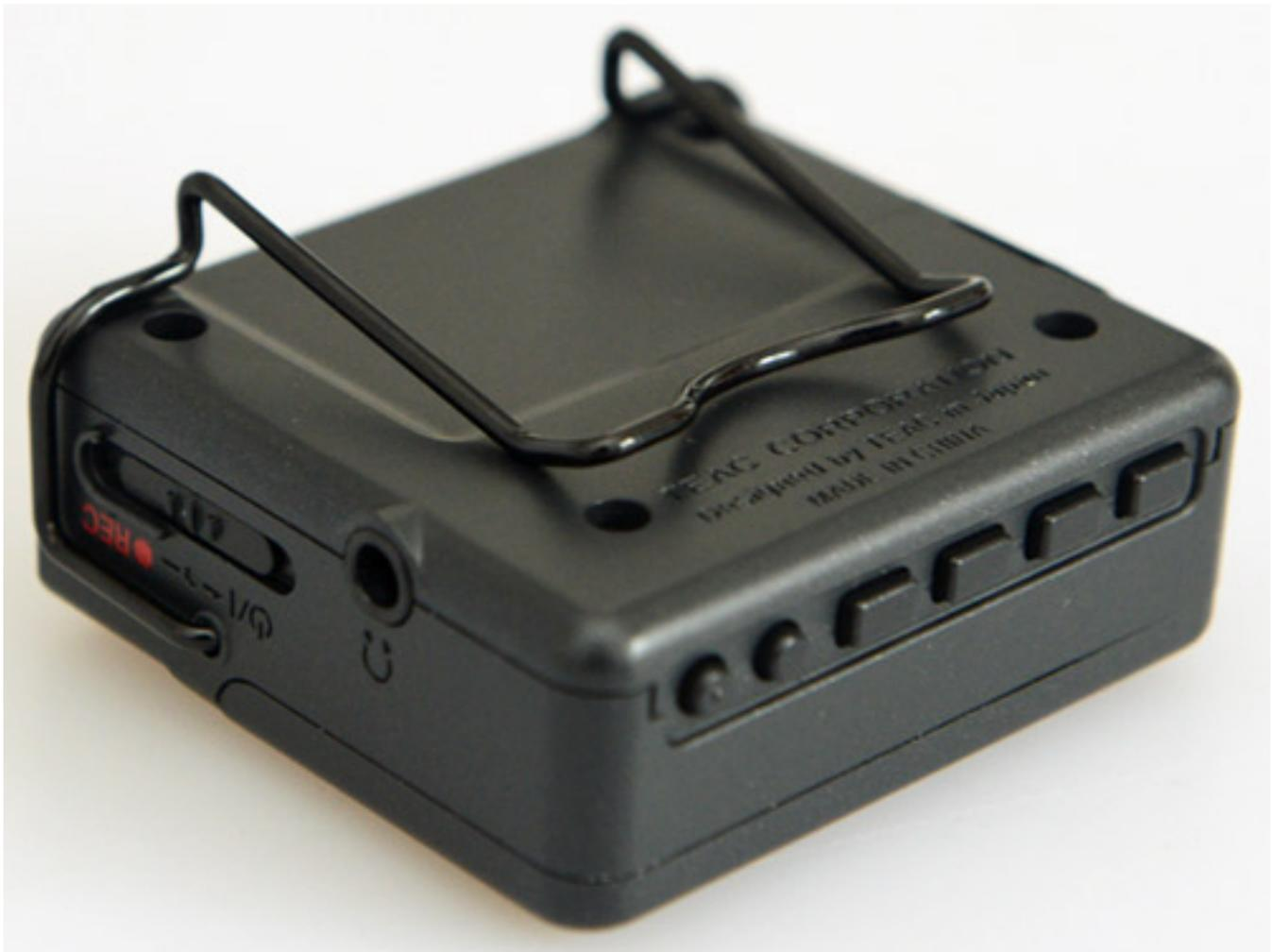
Auf der Seite befindet sich noch ein Kopfhörerausgang (s. Abb. oben) in Form einer 3,5-mm-Stereo-Klinkensteckers. Die Maximalleistung ist hier mit zehn Milliwatt je Kanal angegeben.
