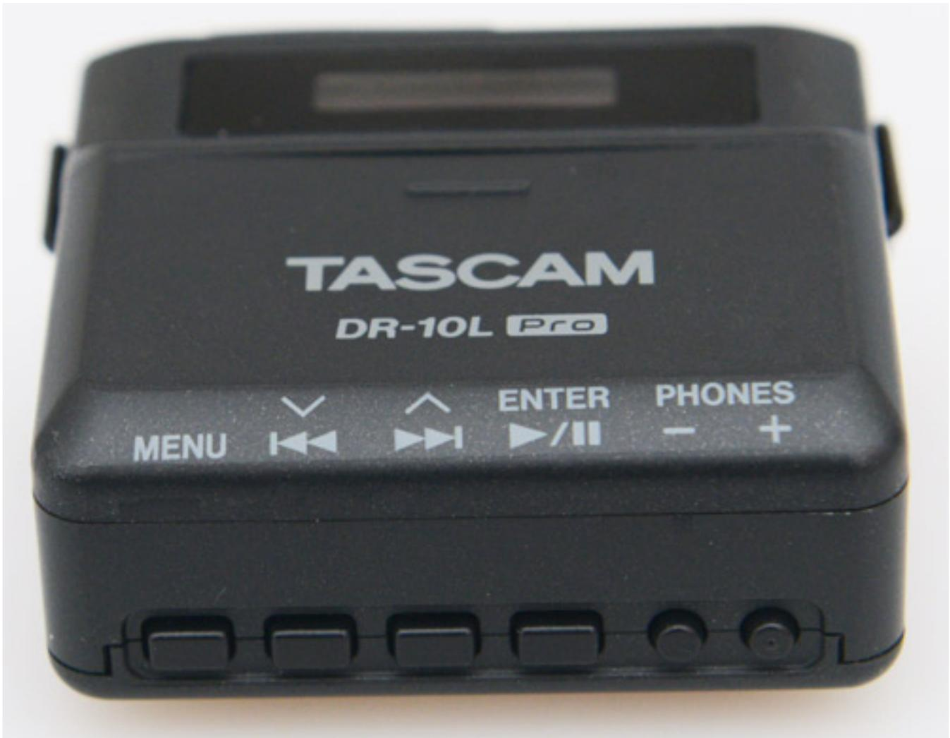
Bei Drücken der Taste MENU öffnet das Menü mit 28 Einträgen. Hier lässt sich sehr viel am Gerät konfigurieren. Mit den Tasten (|<< und >>|) selektiert man den gewünschten Menüpunkt und bestätigt diesen mit der Taste ENTER. Mit den beiden Tasten |<< und >>| kann man nun den Parameter ändern und mit ENTER bestätigen. Dann landet man wieder bei der Menü/Parameter-Auswahl.
