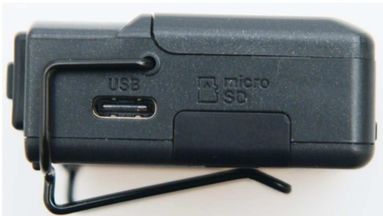
Das USB-Interface ist als USB-C-Buchse ausgeführt. Daneben befindet sich die Abdeckung für den SD-Karteneinschub. Als Karten lassen sich MicroSD, MicroSDHC sowie MicroSDXC (bis 512 GByte) für die Aufzeichnung nutzen. Über den USB-Anschluss lässt sich die Karte auch über einen angeschlossenen Computer im Mass Storage Mode auslesen. Der Modus lässt sich über das Menü am DR-10L Pro aktivieren.
