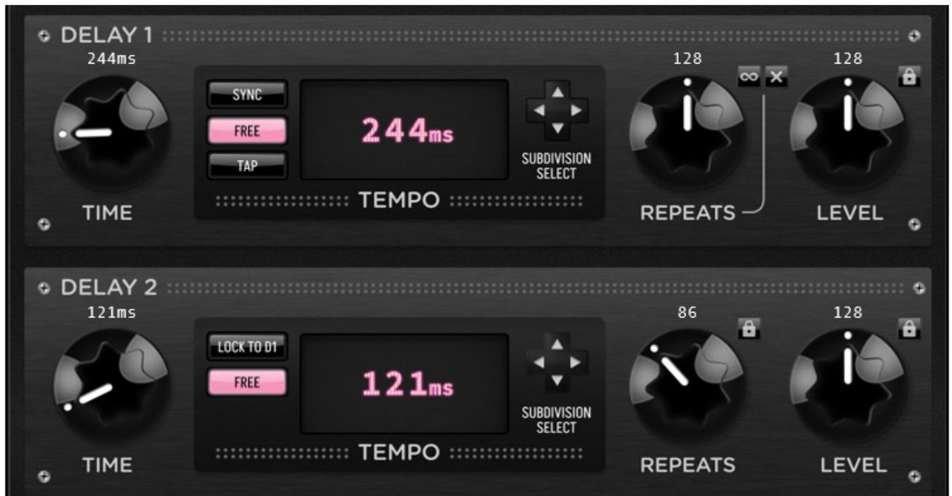
In den beiden unteren Sektionen lässt sich für jedes Delay die Verzögerungszeit und Echo-Wiederholungsanzahl einstellen. Die beiden Delays lassen sich unabhängig oder zeitlich synchronisiert betreiben. Über den virtuellen Taster TAP lässt sich das Tempo auch per rhythmisches Anklicken einstellen.
