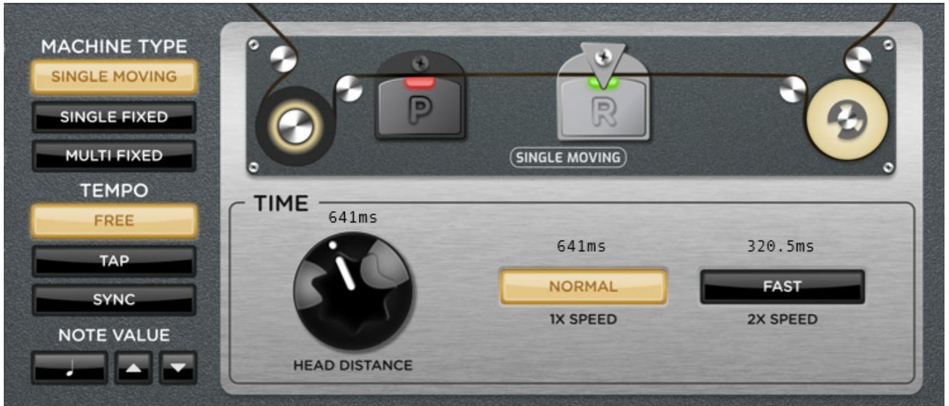
Bei dem Mode SINGLE MOVING lässt sich ein Kopf frei verschieben und die Bandgeschwindigkeit lässt sich unabhängig von der eingestellten Delay, bzw. Kopfposition auch verdoppeln (2x SPEED).
