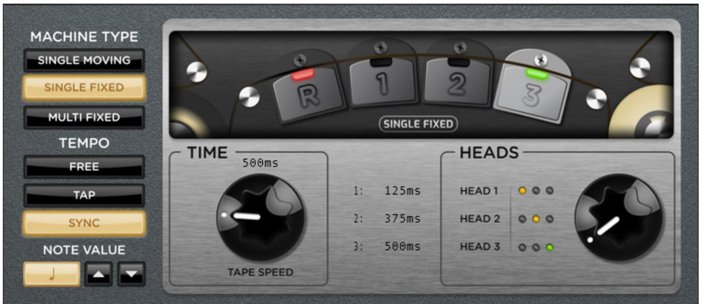
Bei SINGLE FIXED kann einer der drei fest positionierten Köpfe ausgewählt werden, wobei sich die Bandgeschwindigkeit stufenlos einstellen lässt.
