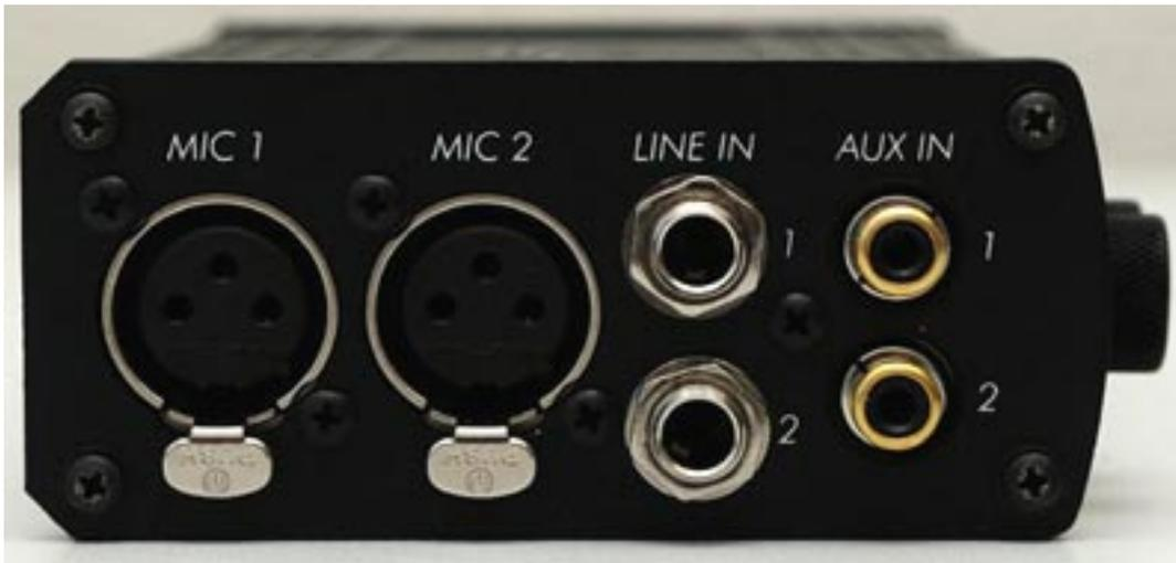
Der USBPre 2 verfügt über zwei elektronisch symmetrierte Mikrofoneingänge mit zuschaltbarer Phantomspeisung. Die Preamps stammen schaltungstechnisch aus der 700-Recording-Familie. Ein -15 dB Pad ist ebenfalls schaltbar. Die Eingangsimpedanz beträgt 4 kOhm. Der Mikrofoneingang verfügt weiter über ein schaltbares Hochpassfilter (80 Hz, 12 dB/Okt.) sowie einen schaltbaren Limiter, der bei -4 dBFS aktiv wird.
