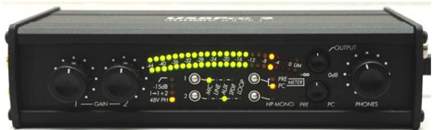
Je nach Betriebsart wird entweder der Ausgangs- oder Kopfhörerpegel mit dem Drehgeber geregelt. Über zwei kleine versenkbare Regler lässt sich einmal die Monitorbalance zwischen PC-Signal und Quelle für den Kopfhörer verändern und zudem auch der Ausgangspegel der XLR- und Aux-Ausgänge über den zweiten Regler einstellen. Über die beiden Regler ganz links auf der Front lässt sich der Eingangsspegel getrennt für beide Kanäle, stufenlos ohne Rasterung, den Erfordernissen anpassen.
