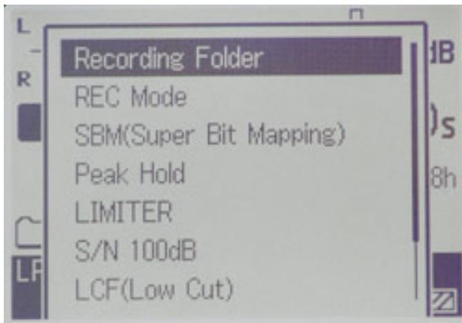
Wenn man in die Recording-Settings geht sieht man dort die verschiedenen Parameter wie Aufnahmeorder, Aufnahmemodus, SBM-Aktivierung, Limiter, Hochpassfilter und andere. Soweit mal ein Beispiel eines Menüs.
