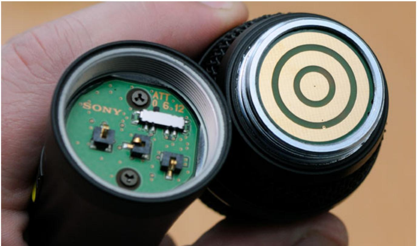
Die Kapsel ist dynamisch mit einer Kugel-Richtcharakteristik. Der Übertragungsbereich des Mikrofons beträgt 70 Hz bis 16 kHz. Es lässt sich eine Dämpfung in drei Stufen einstellen (0/6/12 dB). Der maximale Schalldruck beträgt 142 dB SPL (bei 12 dB Dämpfung).
