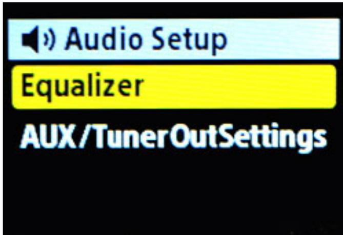
Der Equalizer ist ein Fünfband-EQ. Das Gain jedes Frequenzbandes lässt sich im Bereich von -12 bis +12 dB in 1-dB-Schritten einstellen.
