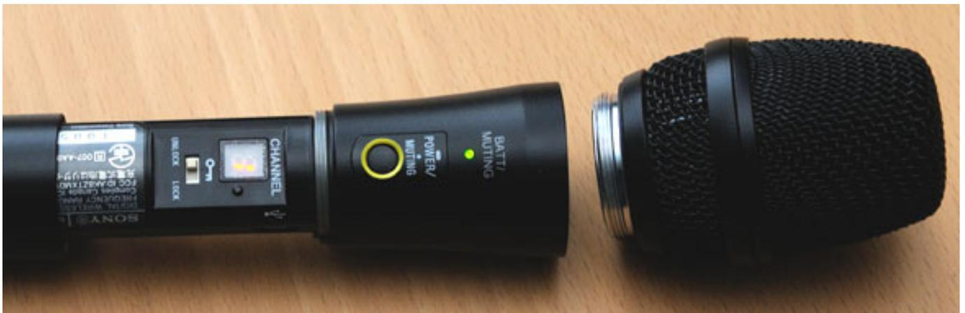
Über einen Druckschalter kann der Anwender den gewünschten Betriebskanal auswählen. Wenn man dieses Miniaturtaster gedrückt hält und den Handsender einschaltet wird die Auswahl des Betriebsmodus angeboten (Wide/Narrow).
