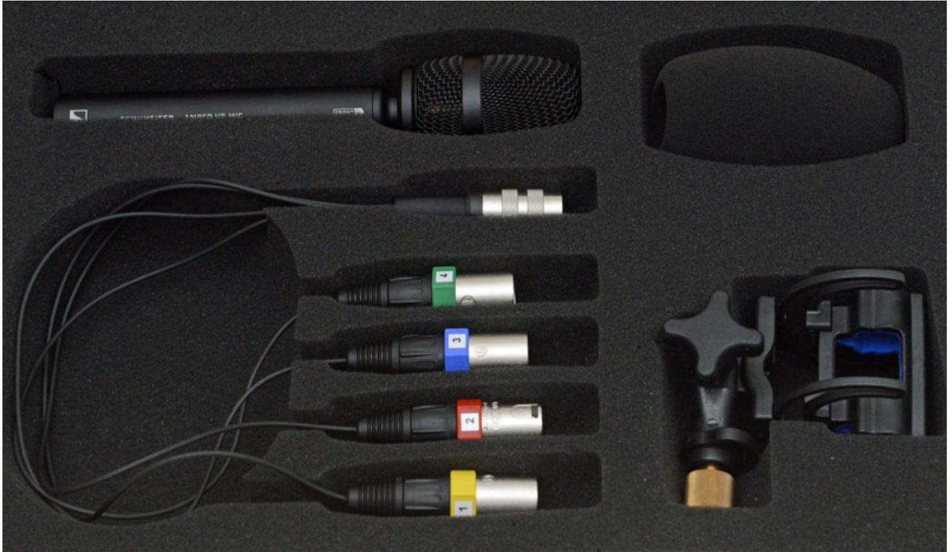
Unten am Mikrofongehäuse ist eine 12-poliger DIN12M-Steckverbindung mit Schraubverriegelung vorhanden. Geliefert wird das Mikrofon mit einem Windschutz sowie eine Kabelpeitsche von 12-pol. DIN auf vier XLR-Steckern und einer elastischen Halterung (s. Abb. unten).
