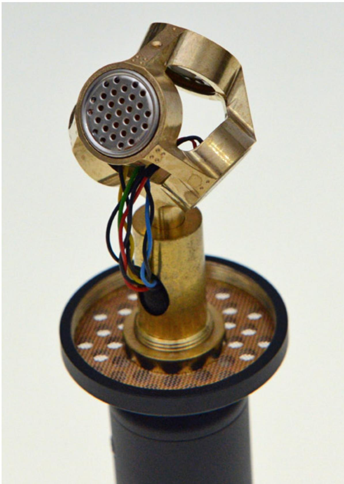
Mit dem AMBEO VR Mic bietet nun auch der renommierte Mikrofonhersteller Sennheiser ein Ambisonic-Mikrofon erster Ordnung, also mit vier Mikrofonkapseln (s.
