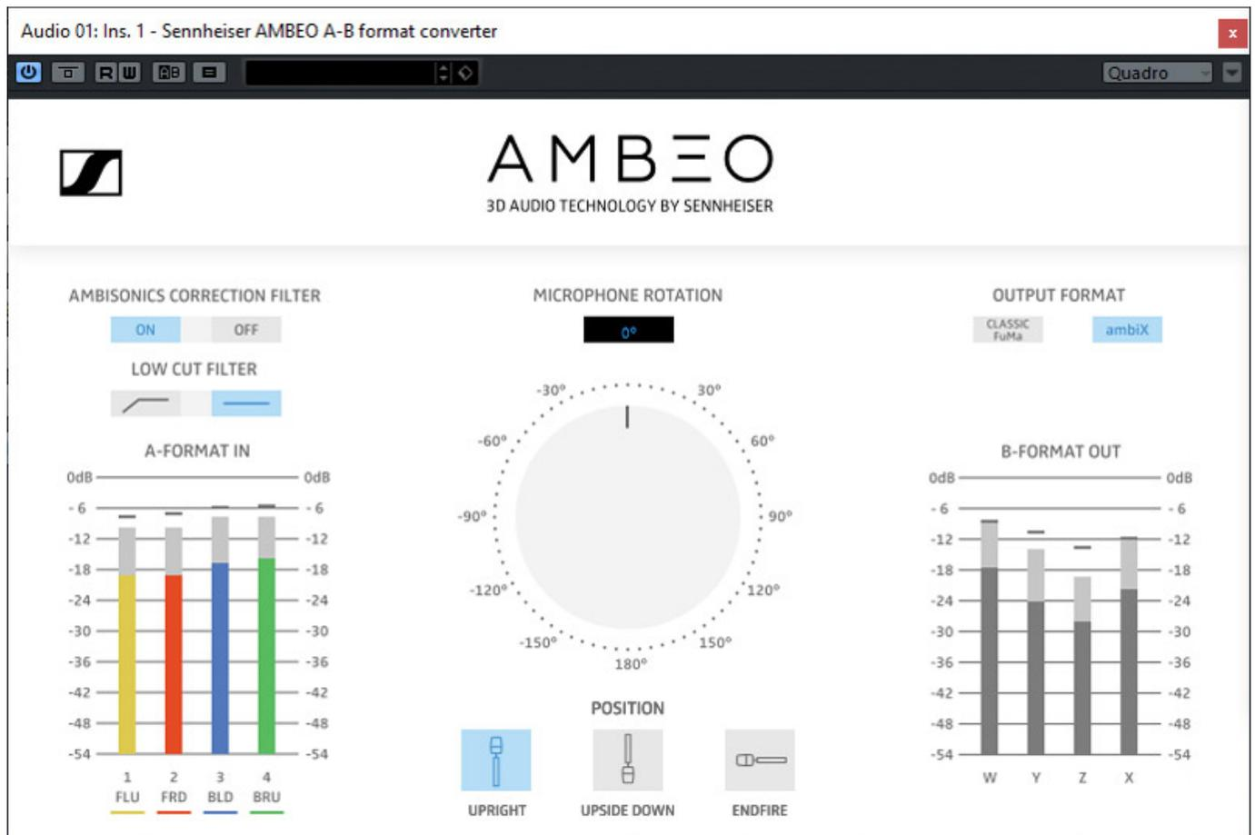
Sennheiser bietet als Download ein Plug-In an, welches die Konvertierung von dem A- in das B-Format vornimmt (s. Abb. oben). Das Plug-In kommt entweder vor Ort auf einem Laptop zum Einsatz oder eben in der Post-Production. Es steht sowohl für Windows-PC als auch für Mac OS-X-Rechner zur Verfügung und zwar in den VST-, AU- oder AAX-Plug-In-Formaten und ist somit auf allen gängigen Workstations nutzbar.
