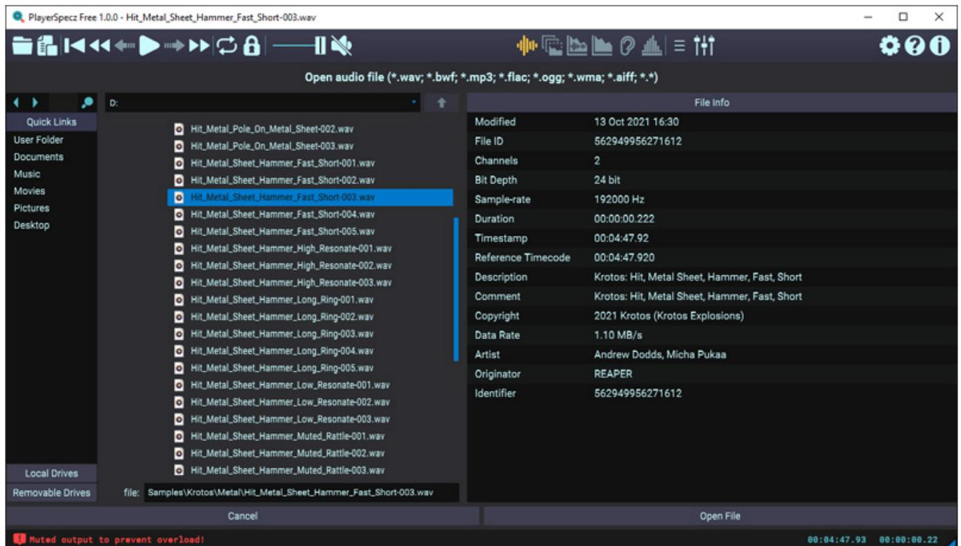
Das erste Symbol (Ordner) gestattet das Laden einer Audiodatei. Hier wird zunächst ein interner Datei-Browser geöffnet und bei Selektieren wird rechts eine Metadatenübersicht ausgegeben (s. Abb. oben). Über den virtuellen Taster "Open File" kann die Audiodatei dann geladen werden.
