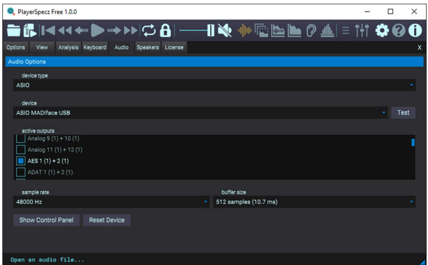
Wie man das von einer professionellen Audio-Software erwartet werden auch Audio-Interfaces mit ASIO-Treiber unterstützt (s. Abb. oben). Die Möglichkeiten der individuellen Anpassung sind extrem umfangreich. Über den Konfigurationsdialog mit mehreren Reitern lassen sich so neben der Treiberauswahl diverse Individualisierungen vornehmen.
