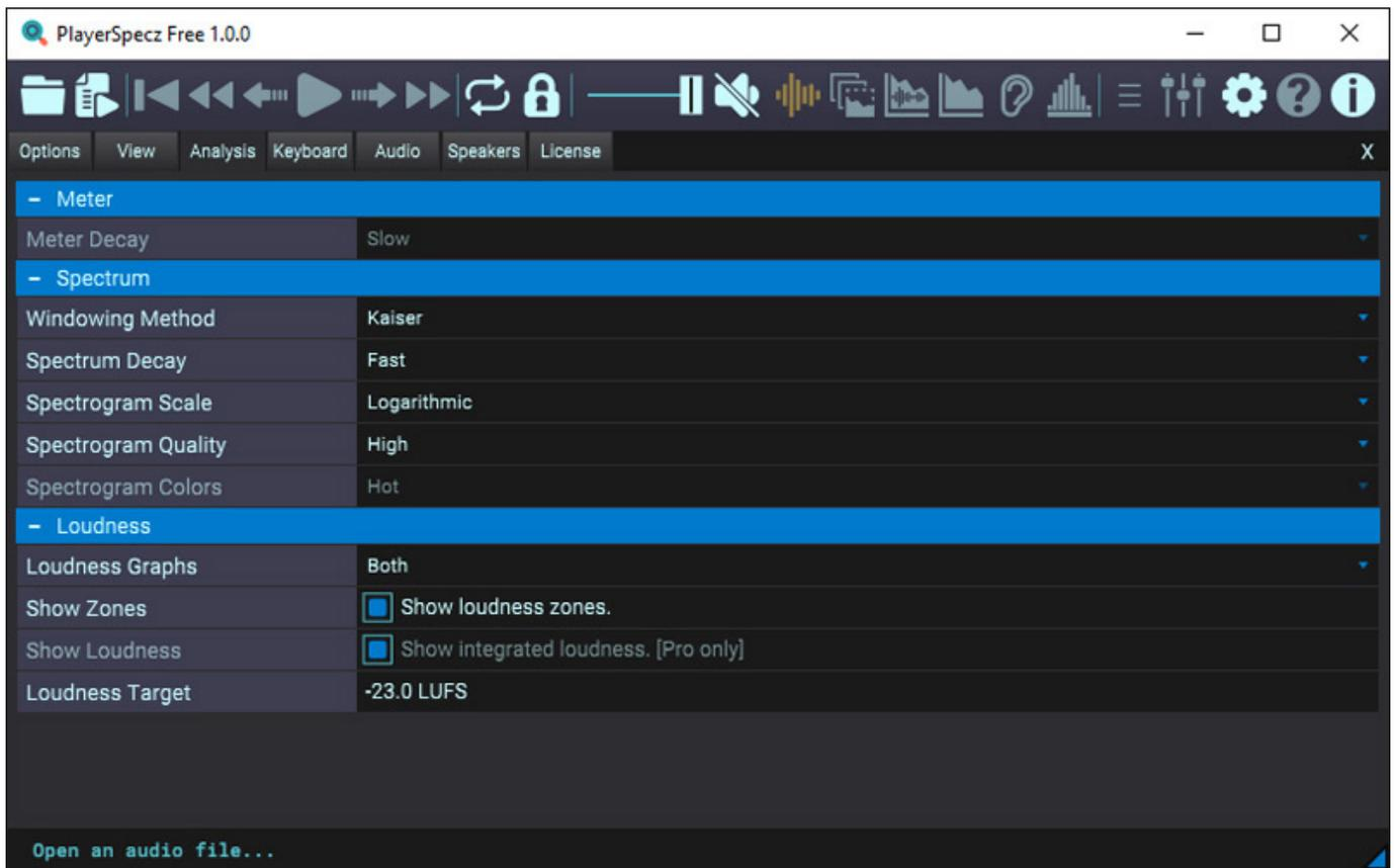
Über "den Reiter "Analysis" kann der Anwender das Meter-Abfallverhalten einstellen sowie Einfluss auf die Analyseparameter für die Spektrumdarstellung und die Lautheitsausgabe vornehmen.
