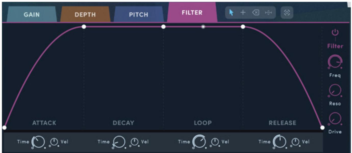
Die vierte Hüllkurve steuert die Grenzfrequenz eines Ladder-Tiefpaßfilters. Hier lässt sich in dem Dialog auch der Frequenz-Offset, Resonanzfaktor und den "Drive" einstellen, der eine Art Sättigungsverhalten produziert.
