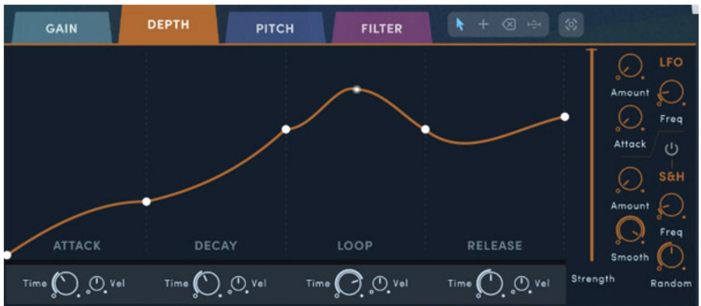
Die Hüllkurve DEPTH (s. Abb. oben) steuert das Abfahren der einzelnen Waves einer Wavetable. Hier steht auch noch zusätzlich ein LFO sowie auch ein Zufallsgenerator zur Modulation zur Verfügung.
