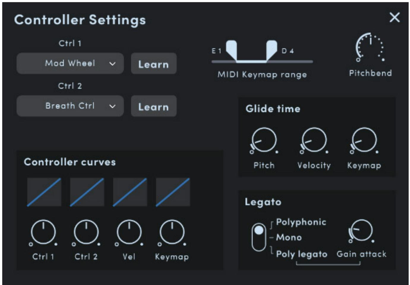
Der Controller-Settings-Dialog ermöglicht ein Anlernen von Controllern für Mod Wheel und Breath Control, wobei sich auch die Übertragungsfunktion zwischen Controller und dem Modulationsziel über eine Kurve anpassen lässt. Weiter kann der Anwender hier die Glide-Funktion anpassen und die polyphone Spielweise lässt sich unter anderem festlegen.
