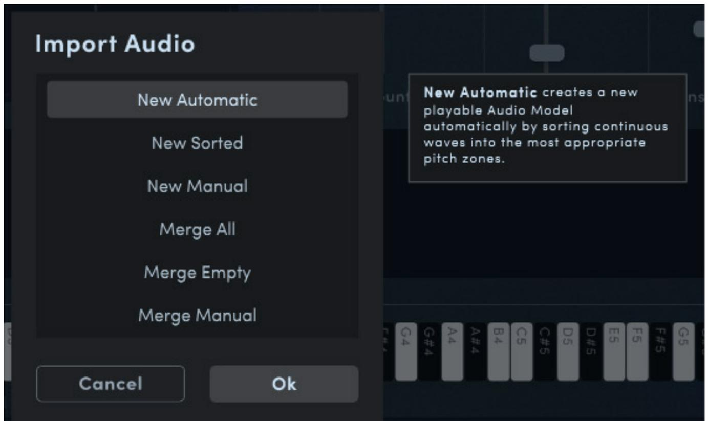
Nun kann man verschiedene Betriebsarten wählen, wie das Audio importiert werden soll und wie es in Zusammenhang mit einem ggf. schon geladenem Audio Modell behandelt ("Merge" Modes) wird. Über den Modus "New Automatic" wird ein neues Modell angelegt und die Zuordnung der Pitch Zones wird automatisch vorgenommen. Bei den Modes "Manual" wird die Zuordnung vom Anwender vorgenommen.
