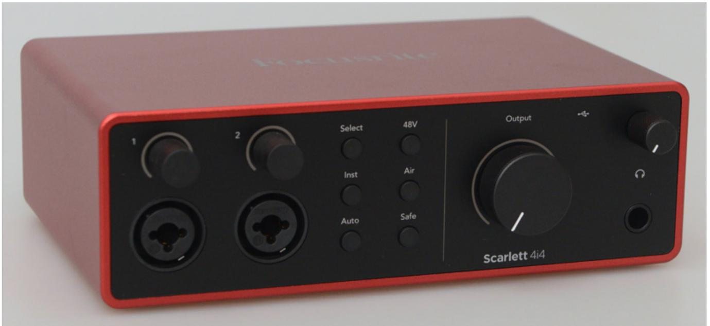
Das Scarlett 4i4-Audiointerface verfügt über zwei Eingänge in Form von Kombibuchsen auf der Vorderseite und zwei 6,3-mm-Klinkenbuchsen auf der Rückseite. Ausgangsseitig werden auf der Vorderseite ein Kopfhörerausgang in Form einer 6,3-mm-Stereoklinke sowie vier 6,3 mm-Klinkenbuchsen geboten. Beim Scarlett 2i2 stehen ausschließlich Klinkenbuchsen für die Eingänge auf der Frontseite zur Verfügung.
