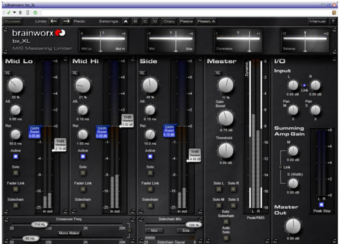
Sowohl Gain und Schwellwert, als auch Ansprechzeiten (Attack/Release), sowie ein Maximizer-Parameter lassen sich in den drei Signalfaden einstellen - Threshold und Gain sinnvollerweise im Bargraf-Display. Die Einstellung der Masterparameter wirken auf alle drei Pfade zusammen.
