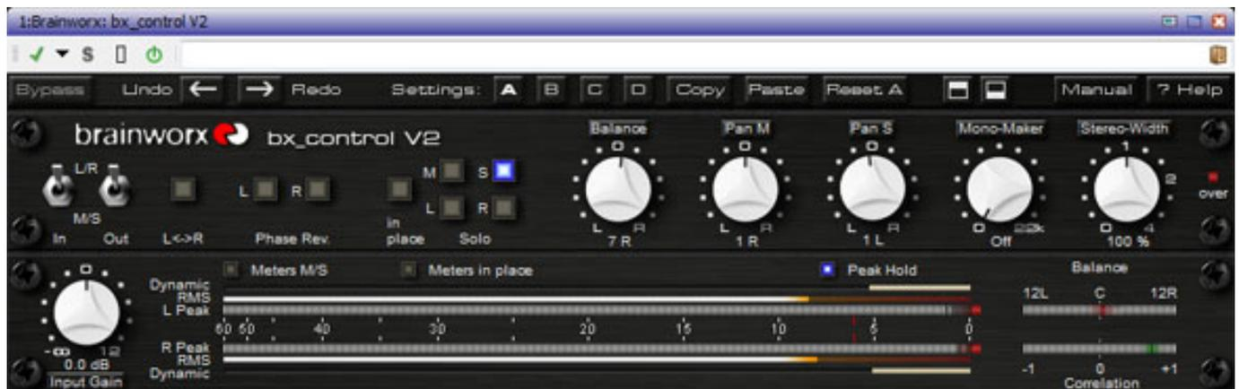
Der bx\_control ist eine M/S-Matrix zum Abhören und ein Stereo-Panorama-Tool in einem. Auf der linken Seite lässt sich anwählen was man Abhören möchte und wie die Matrizierung erfolgen soll (L/R-M/S-Schalter links). Dann gibt es rechts Regler für die Einstellung der Stereo-Balance, sowie des Mid- und Side-Panorama.
