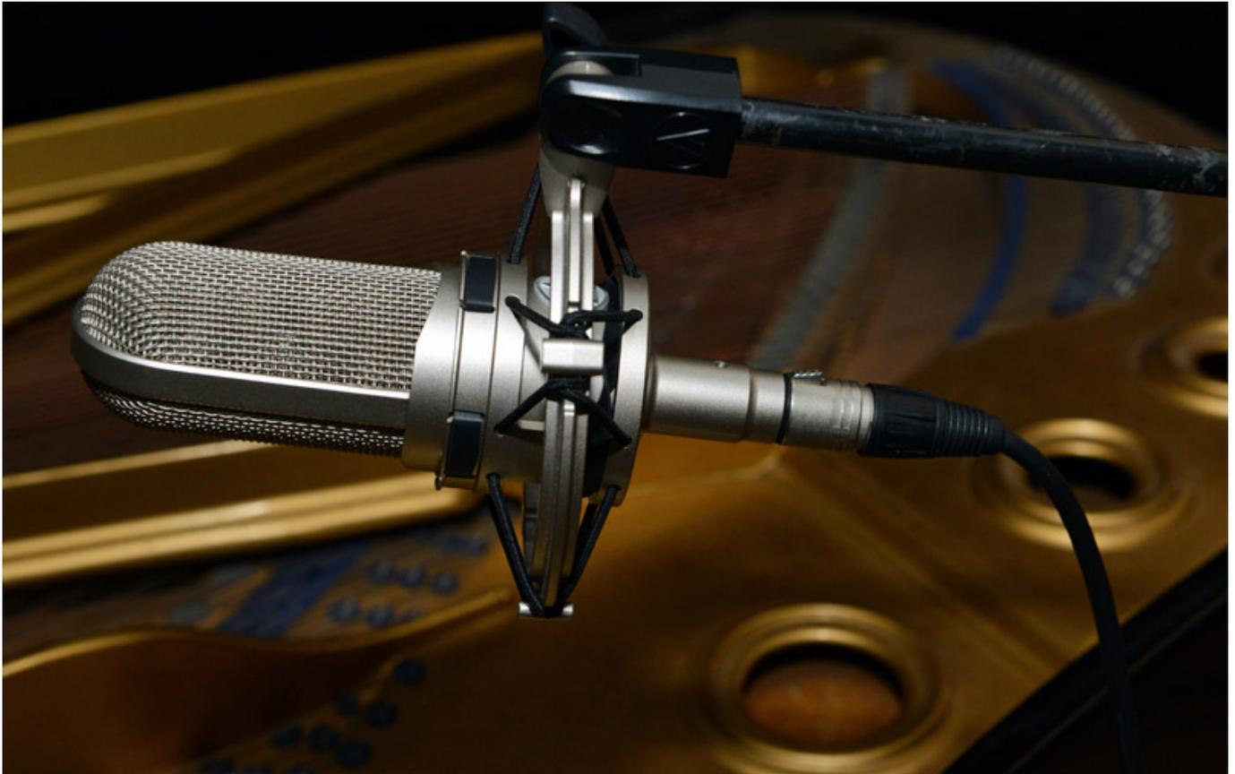
Das AT4080 ist im klassischen Studiomikrofon-Design. Die Ausgangsimpedanz beträgt 100 Ohm und der maximale Schalleingangspegel beachtliche 150 dB SPL (@ 1 kHz, 1 % THD). Das Eigenrauschen beträgt 22 dB SPS und der Dynamikumfang 128 dB (@ 1 kHz, 1 % THD). Der Strom bei angeschlossener Phantomspeisung beträgt ca. 3 mA. Den Übertragungsbereich gibt der Hersteller mit 20 Hz ... 18 kHz an.
