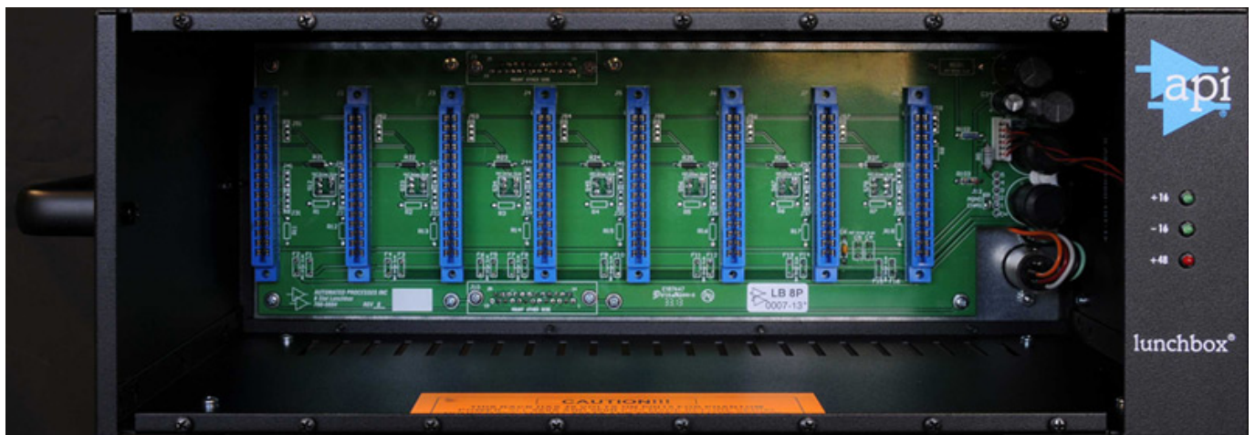
API 500-8B Lunchbox mit interner Spannungsversorgung
