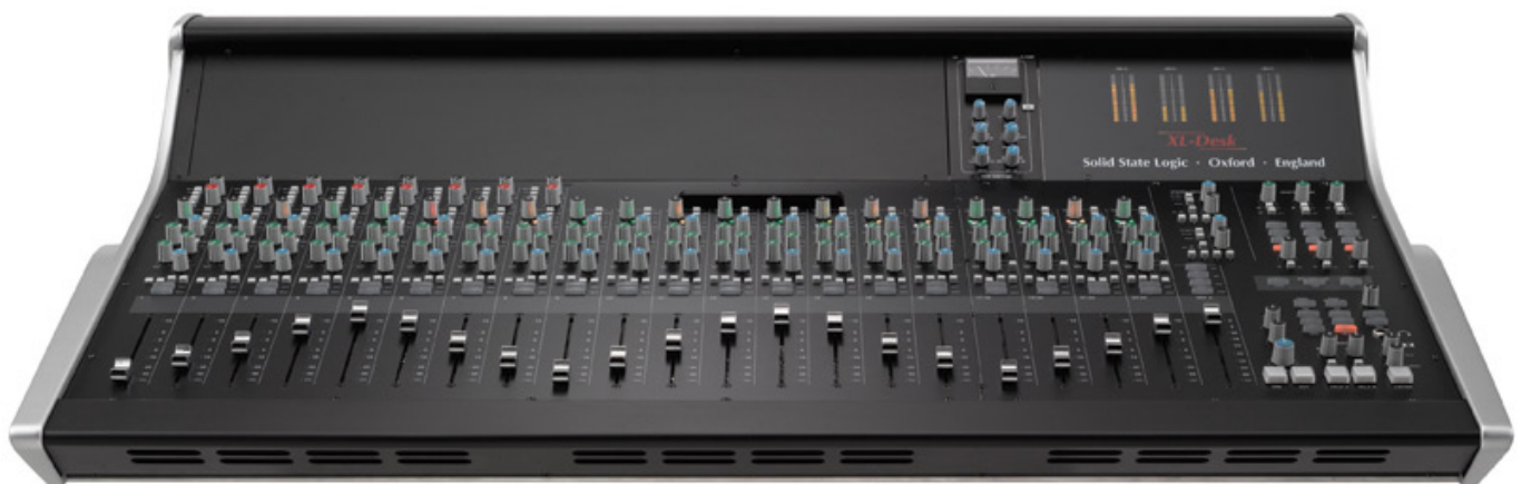
SSL XL Desk mit sechzehn API-kompatiblen 500er-Modul-Slots (hier mit Blank-Panel)
