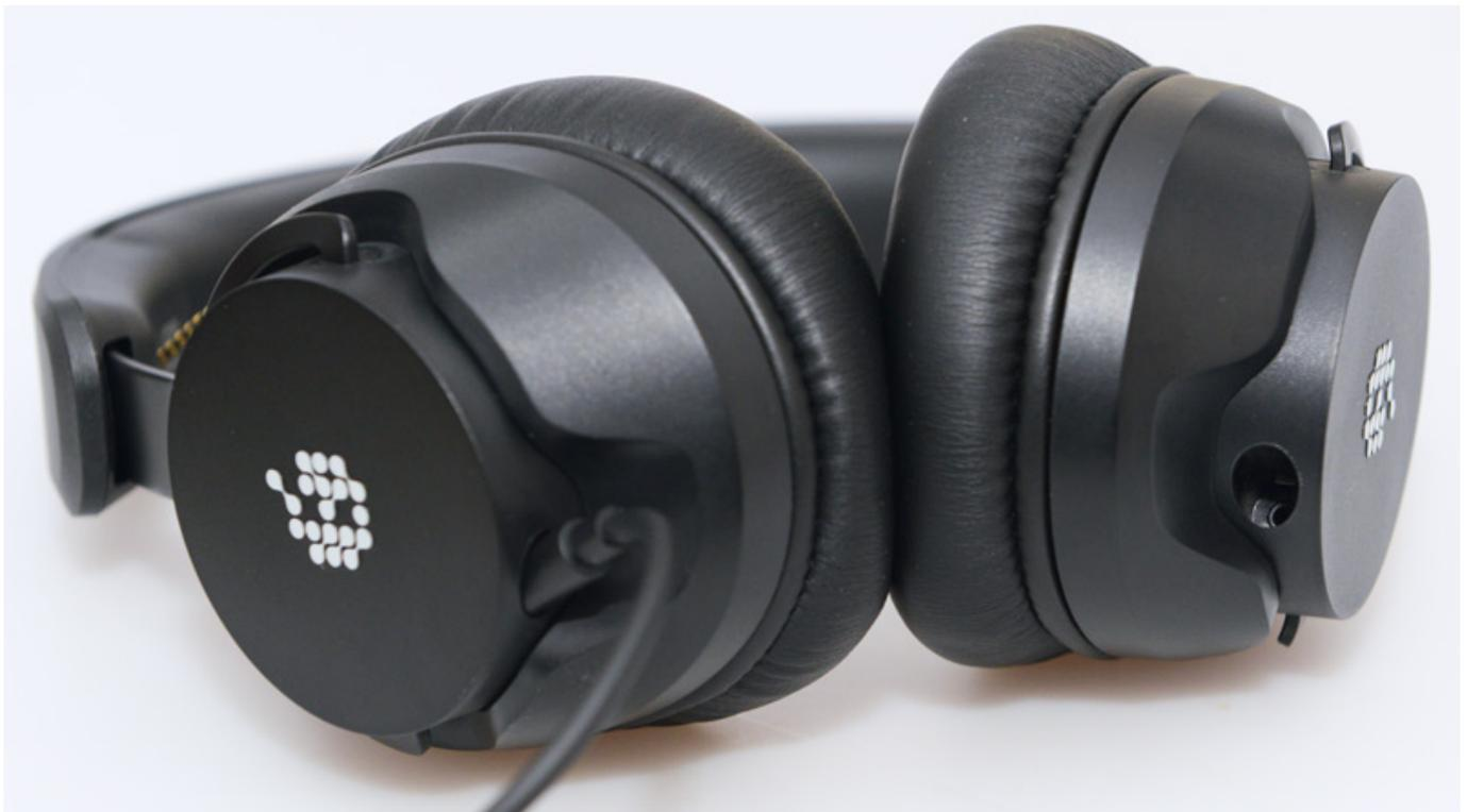
Das Gewicht des Kopfhörers liegt bei ca. 250 Gramm ohne Kabel und das Gehäuse ist zu 85 Prozent aus recyceltem ABS-Kunststoff hergestellt. Auf beiden Seiten des Kopfhörers ist jeweils eine 2,5-mm-Klinkenbuchse für den Anschluss des Kopfhörerkabels vorhanden. Das Kabel kann also links oder rechts eingesteckt werden (s. Abb. oben) und wird mechanisch vor versehentlichem Ausstecken gesperrt.
