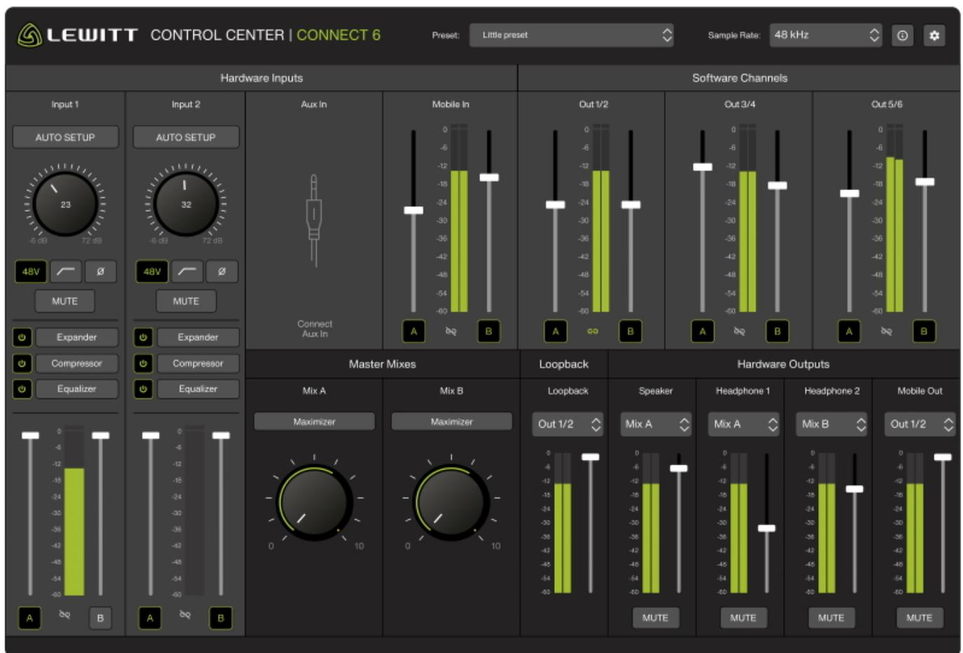
Mix A kann dann z.B für Monitoring verwendet werden, während Mix B z.B in eine DAW, Streaming-Software oder ein virtuelles Meeting gesendet wird. Dank der Smartphone Integration via USB-C kannst du deinen Mix auch an mobile Apps senden. Beide Mix-Ausgänge verfügen über einen einfach zu bedienenden Maximizer, um den optimalen Lautstärkepegel sicherzustellen.
