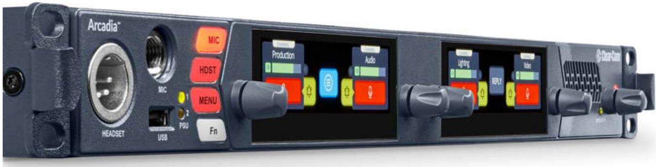
Clear-Com stellt mit der Arcadia Zentrale eine skalierbare IP-Plattform der nächsten Generation vor, die alle drahtgebundenen und drahtlosen Partyline-Systeme einschließlich der FreeSpeak- wie auch der HelixNet-Familie integriert. Das System bietet bis zu 96 IP-Ports in einer einzigen Höheneinheit. Verschiedene Lizenzerweiterungen sind bereits für die Zukunft vorgesehen, was Arcadia zur idealen Intercom-Zentrale für eine Vielzahl von partyline-basierten Anwendungen macht.
