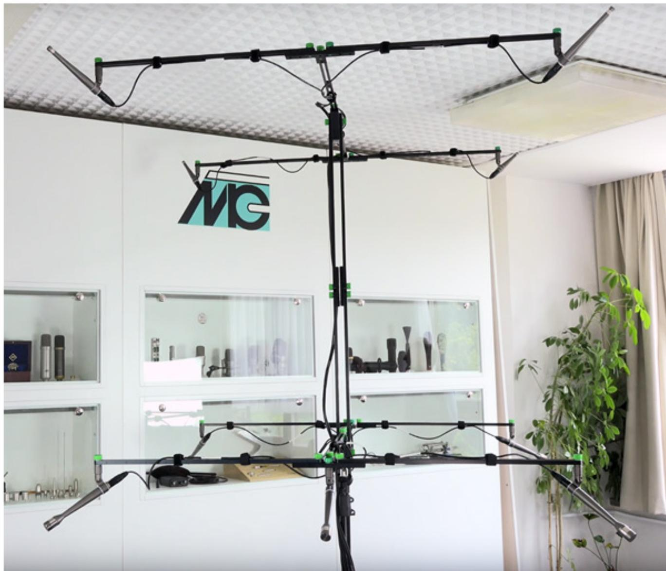
In diesem Video wird das M-Cube Mikrofonsystem für 3D-Audio-Aufnahmen vorgestellt und technische Hintergründe und Anwendungsmöglichkeiten erläutert.
