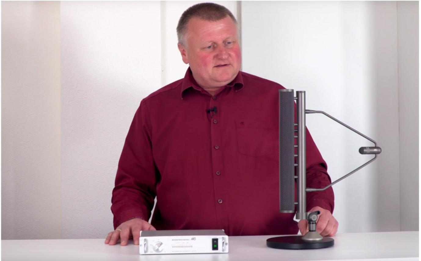
Das KEM 975 ist ein Linearray-Mikrofonsystem mit einer weitgehend frequenzunabhängigen Richtcharakteristik, die in der Horizontalebene die Eigenschaft eines Nierenmikrofons und in der Vertikalebene die eines Richtmikrofons mit einem Öffnungswinkel von ca. 30 Grad aufweist. Aufgrund dieser besonderen Aufnahmecharakteristik eignet sich das KEM 975 für Chor- und Orchesteraufzeichnungen sowie als Sprechermikrofon in Hörsälen und Konferenzräumen.
