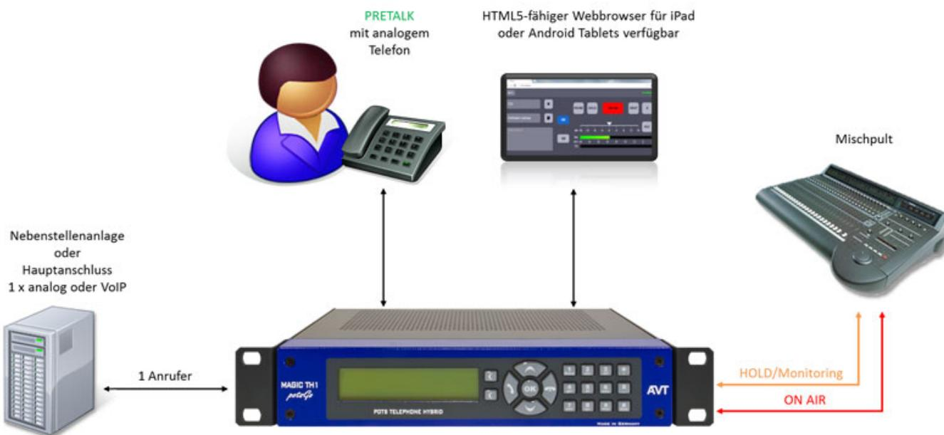
Der MAGIC TH1ipGo Telefonhybrid verfügt über eine LAN-Schnittstelle und kann damit als Voice-over-IP-Telefonhybrid (mit HD Voice) für einen Anrufer genutzt werden. Als Audioschnittstellen stehen zwei analoge Audioein- und Audioausgänge zur Verfügung.
