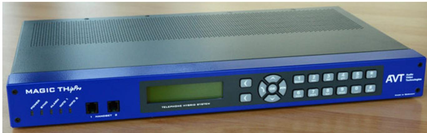
Der THipPro von AVT ist ein sehr universeller Telefonhybrid-System für den Betrieb mit analogen Telefonleitungen, ISDN sowie VoIP und das auch im gemischten Betrieb.
