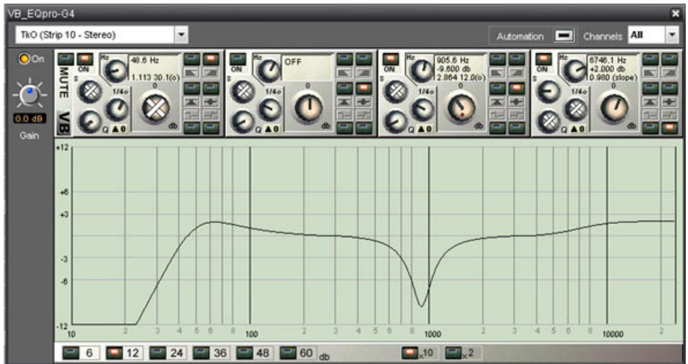
Der Bandbreitebereich von 1/24 bis zwei Oktaven ermöglicht flexibles eingreifen und ein großes grafisches Display gewährt schnellen Überblick über diese Eingriffe. Alle Bänder lassen sich individuelle ein- und ausschalten. Der Gainbereich beträgt +/- 32 dB. Eine Notch-Variante dieses Plug-Ins ermöglicht hingegen fokussiertes bearbeiten und das Unterdrücken von Frequenzen.
