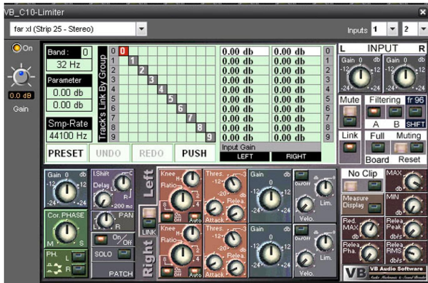
Zu Beginn wird das Eingangssignal in zehn Oktaven separiert. Jedes Band ist ab dann diskret mit folgenden Einheiten zu bearbeiten ON/OFF, Input Gain, Phasenkorrelation, Phasenumdrehung, Delay, Pan, Kompressor-Modul, Gain nach Kompressor und Limiter. Zur Arbeitserleichterung steht eine Link-Matrix, welche jegliche Kombination von Bearbeitungsgruppen ermöglicht und eine Undo/Redo Funktion zur Verfügung.
