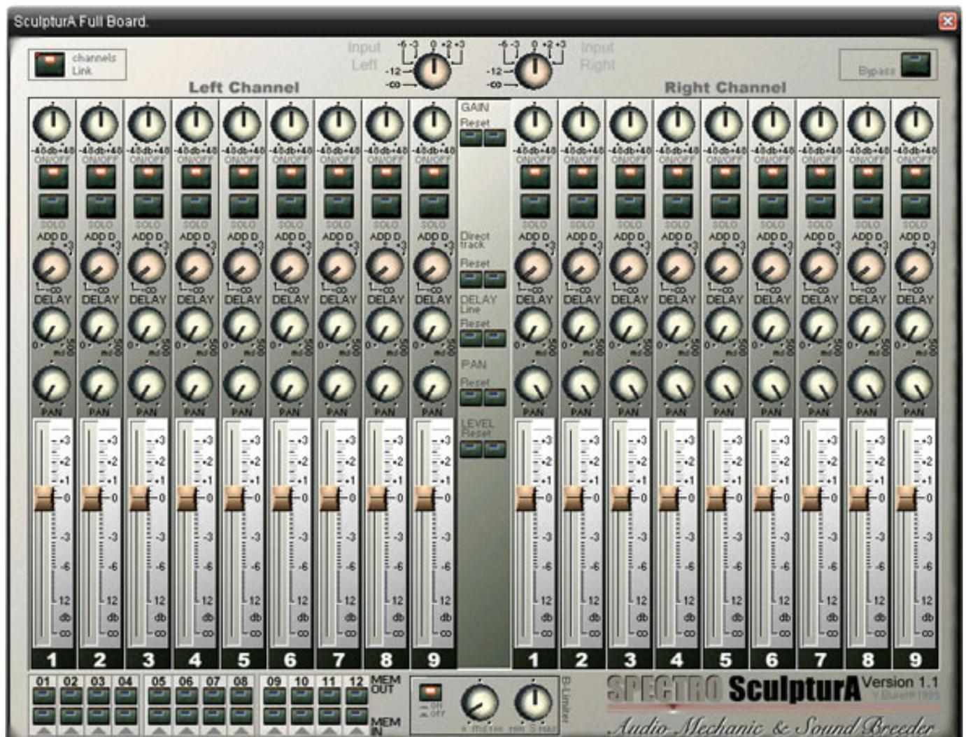
Zudem ermöglicht er über ein Delay das zeitliche verschieben jedes Bandes separat je Kanal und das schnelle vergleichen von Einstellungen. Erwünschte oder unerwünschte Frequenzüberlagerungen lassen sich hiermit schnell und effizient vornehmen.
