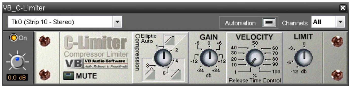
Ein kleiner effektiver CPU schonender BrickWall Limiter. Er bietet auch noch ein kleine Kompressoreinheit, welche das Verstärken des Signales über die üblichen Grenzen hinaus ermöglicht und trotzdem auf 0dB FS begrenzt. Der B-Limiter in diesem Pack bietet statt Kompression eine Look-Ahead-Funktion an, verursacht somit aber auch leichte Latenz und ein Distorsion-Regler erlaubt Einfluss auf den Verzerrungsgrad.
