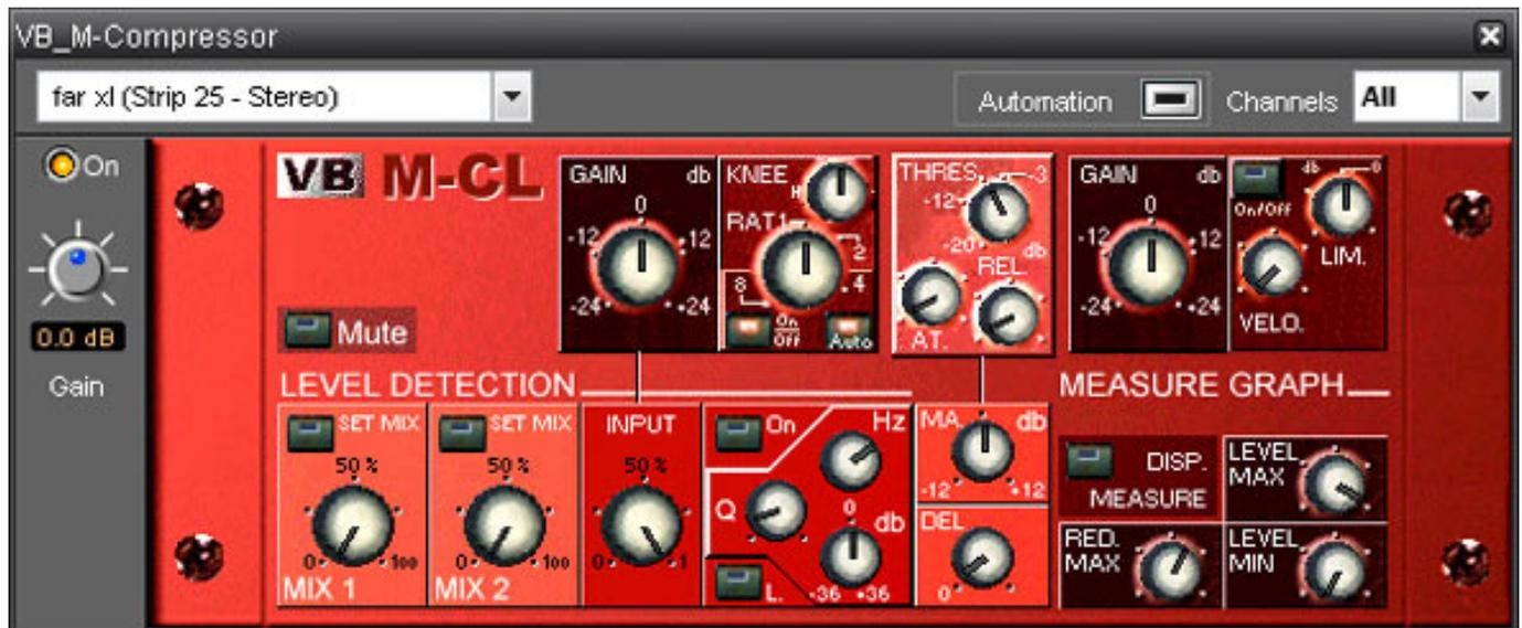
Die Kompressionseinheit bietet neben allen gewohnten Parameter noch eine stufenlos verstellbare Knee-Einstellung und ein Autogain welches Pegeländerung durch Kompression kompensiert, man also nur Veränderung von Kompressionsgrad aber nicht Lautstärke erhält. Eine weitere Side-Chain-Funktion ermöglicht das definieren einer Frequenz welche ähnlich einem De-Esser besonders bei der Kompression berücksichtigen werden soll.
