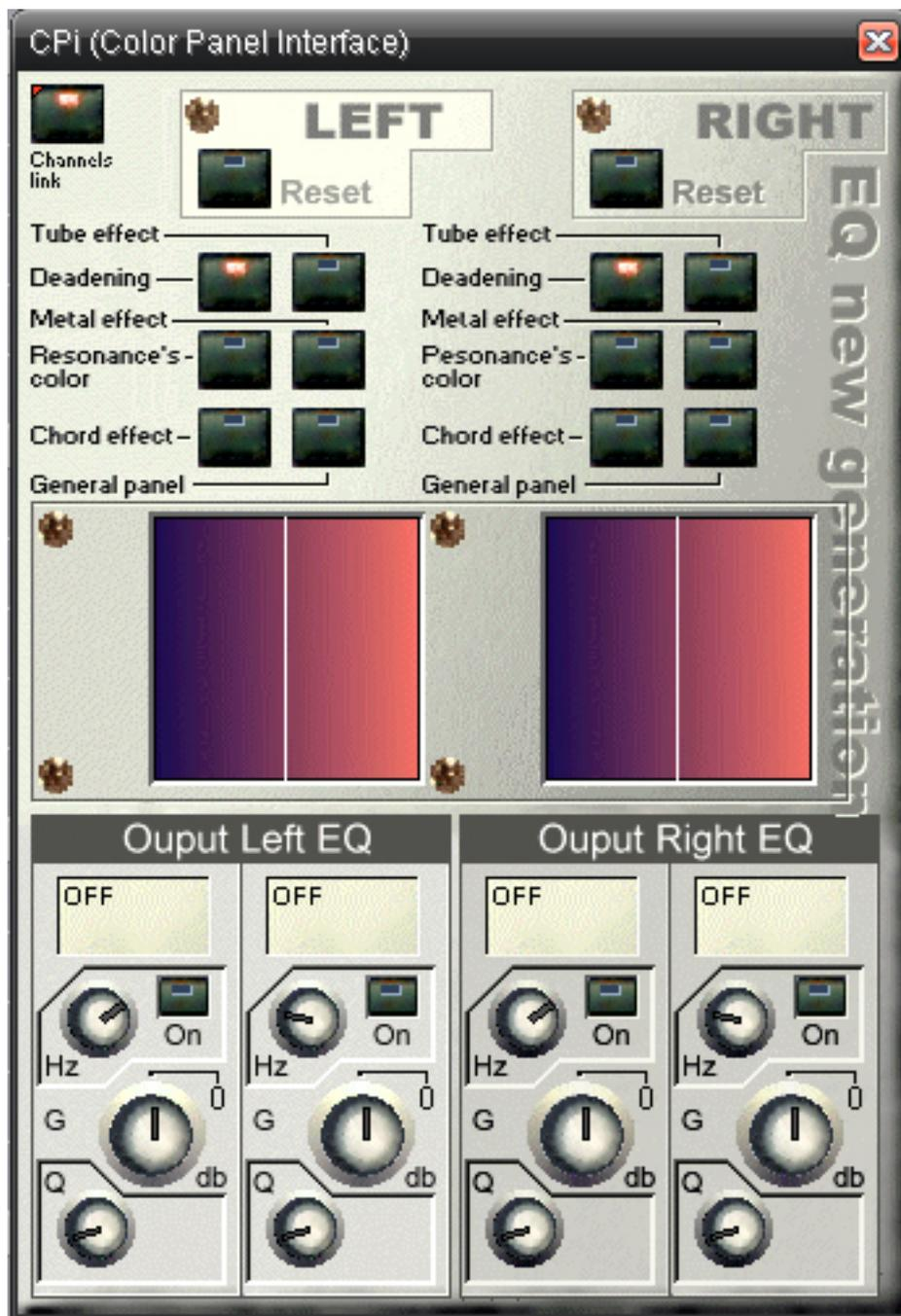
Hinter den beiden unscheinbaren Knöpfen CP und AC verbergen sich umfangreiche Einstellmöglichkeiten. Im Color Panel sind die beiden Kanäle ebenfalls einzeln einstellbar und es steht neben zwei vollparametrischen EQ Bändern je Kanal ein Interface zur Verfügung das Einfluss auf die Frequenz Response wie Tube-Effekte ermöglicht. Algorithmen ermöglichen umfangreiche Bearbeitungsmöglichkeiten der frühen Reflektionen, Klangentwicklung und Ausklang.
