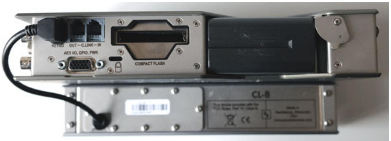
Auf der rechten Seite des Recorders befinden sich acht analoge Mic/Line-Eingänge - vier ausgeführt als XLR- und vier als MINI-DIN-Buchsen. Hier ist auch der Regler für den Pegel des Kopfhörerverstärkers angebracht. Die Eingänge sind auch mit einer zuschaltbaren 48-Volt- Phantomspannung versehen.
