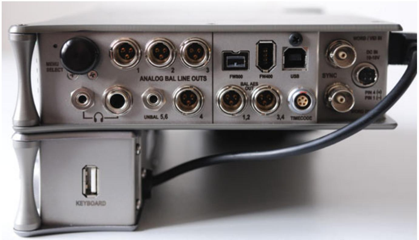
Für die Synchronisation ist der 788-T standardmäßig mit Timecode-Schnittstelle (Ein-/Ausgangs, LEMO-Buchse) sowie mit Word-Clock-Ein- und Ausgang (BNC) ausgestattet. Ein Timecode-Generator ist ebenfalls vorhanden.
