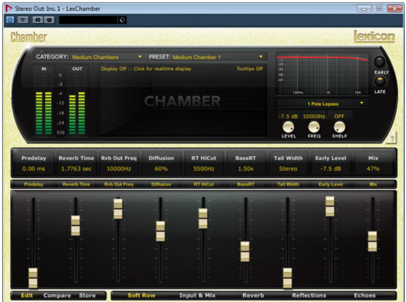
Der Algorithmus **Chamber** simuliert einen klassischen Hallraum, bei dem ein Signal zur Anregung über Lautsprecher in den Raum gegeben wird und die Antwort vom Raum mit einem Mikrofon aufgenommen wird.
