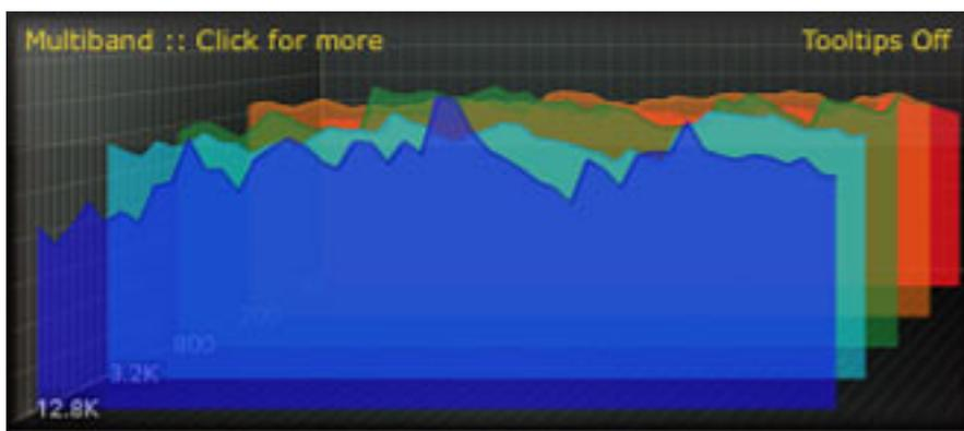
Im oberen Bereich ist wird auch die Filterkurve für die Early (blau) und Late Reflections (rot) ausgegeben und die Filterparameter lassen sich hier auch einstellen. Es sind hier verschiedene Filtertypen anwählbar und zwar: Hoch-/Tiefpaß erster Ordnung (6 dB/Okt. Steilheit), Hoch-/Tiefpaß zweiter Ordnung (2 dB/Okt. Steilheit), Bandpass und Notch-Filter.
