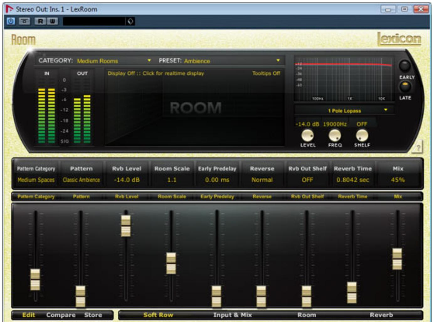
Der Algorithmus **Room** wurde mit dem PCM 96 bei Lexicon eingeführt und simuliert einen kleineren Raum, wie man ihn für die Post-Production aber auch für Musikinstrumente einsetzen kann, z. B. Percussion, Drums oder Gitarre.
