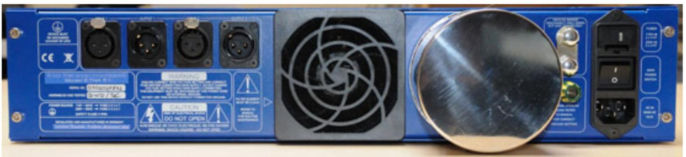
Auf der Rückseite erkennt man sofort den nach außen ausgelagerten Ringkerntransformator. Rechts daneben befindet sich eine 4-mm-Buchse für die Erdung. Darüber ist eine Erdungsbrücke, die man entfernen muss, wenn der Schutzleiter nicht über das Netzkabel zugeführt wird. Betrieb ist mit 115- oder 230-Volt-Netzspannung möglich (umschaltbar). Über einen Ventilator wird das Innere zwangsgekühlt. Der Ventilator verfügt über einen Luftfilter, der sich ausbauen und reinigen lässt.
