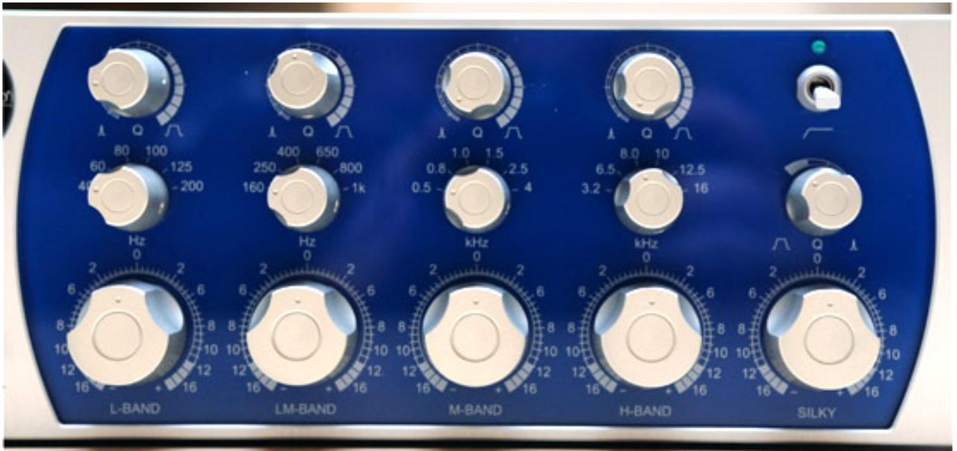
Jeder der beiden Equalizer lässt sich über einen Kippschalter in der Mitte der Gerätefront aktivieren oder überbrücken. Ein Linking für Stereobetrieb ist nicht vorgesehen. Die vier vollparametrischen Bänder sind von der Bedienung her identisch aufgebaut. Es gibt einen sechsstufigen Schalter für die Frequenzwahl und je ein Poti für Gain und Güte. Beim Silky-Höhenfilter ist die Güte fest. Über dem Gain Regler des Silky-Filters ist der Schalter für die Zuschaltung des Hochpassen angebracht.
