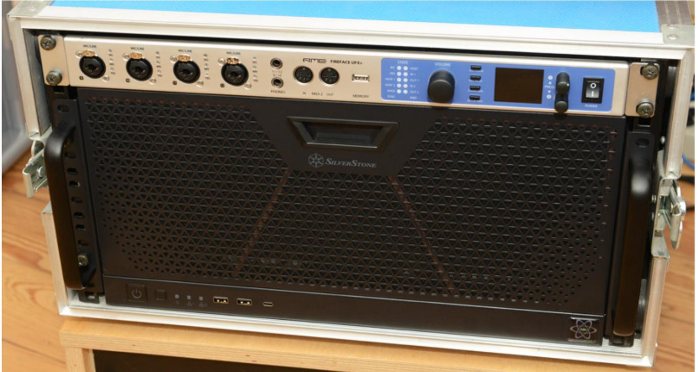
Zunächst einmal zum Gehäuse. Die 19-Zoll-Rackwinkel an der Seite sind etwas kürzer und decken nicht die ganzen 5 HE hohen Bereich ab. Bei unserem Rack konnte man nicht die Löcher über und unter dem Griff nutzen was aber kein Problem darstellte, da an den Winkeln jeweils elf Befestigungslöcher vorhanden sind. Auf eine Auflageführung haben wir - entgegen dem früheren Rechner - verzichtet, denn das Gewicht kann man so gerade noch ohne Auflage ins Rack bringen.
