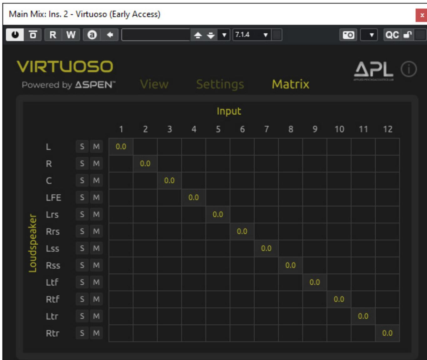
Über den Reiter "Matrix" lassen sich dann auch noch die Kanalreihenfolge und die Pegel verändern und die einzelnen Kanäle können auf Solo, bzw. stummschalten werden (s. Abb. oben).
