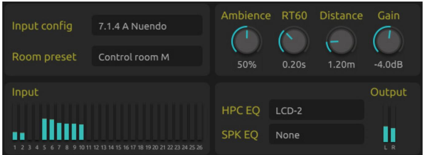
Wechselt man auf einen anderen Reiter so wird der obere Teil des Dialogs entsprechend geändert. Der untere Bereich mit der Eingangskonfiguration, dem Preset der Raumsimulation (APL Listening Room, Control Room small, medium, large, Dubbing Stage, Home Cinema Living Room) und der Raumsimulationsparameter sowie einer Kopfhörer-EQ-Kompensation als auch einer zusätzlichen Lautsprecher-EQ-Kurve, ist immer identisch und immer verfügbar.
