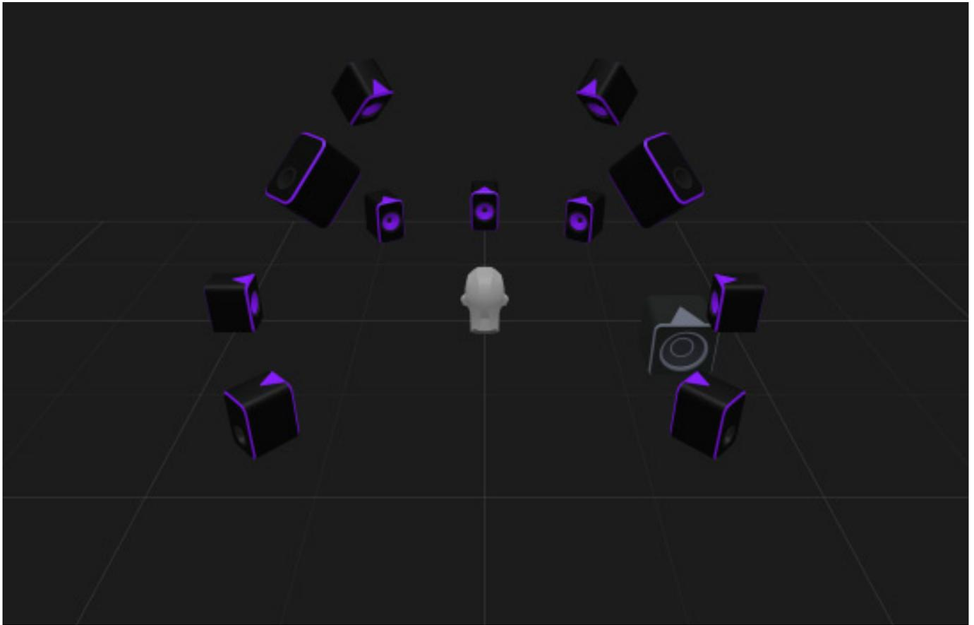
Nehmen wir zum Beispiel einmal Dolby Atmos als Beispiel und dort die Konfiguration 7.1.4. Man sieht, dass es hier zwei Varianten gibt und zwar A und B wobei bei der Variante B (s. Abb. unten) die vier Surround-Speaker etwas weiter nach hinten verschoben sind, also mit größerem Aufstellwinkel. Dolby Atmos lässt hier ja Spielraum durch empfohlene Winkelbereiche und das berücksichtigt man durch die Varianten.
