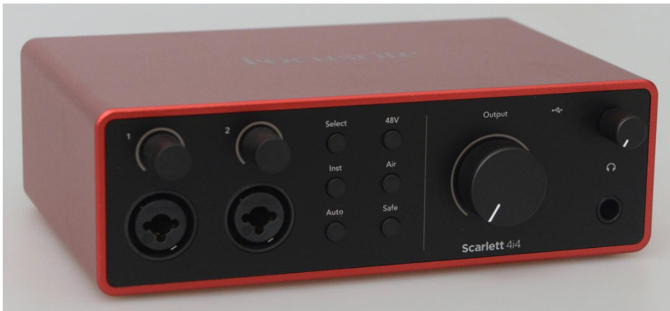
Das Scarlett 4i4-Audiointerface verfügt über zwei Eingänge in Form von Kombibuchsen auf der Vorderseite und zwei 6,3-mm-Klinkenbuchsen auf der Rückseite. Ausgangsseitig werden auf der Vorderseite ein Kopfhörerausgang in Form einer 6,3-mm-Stereoklinke sowie vier 6,3 mm-Klinkenbuchsen geboten. Beim Scarlett 2i2 stehen ausschließlich Klinkenbuchsen für die Eingänge auf der Frontseite zur Verfügung.
