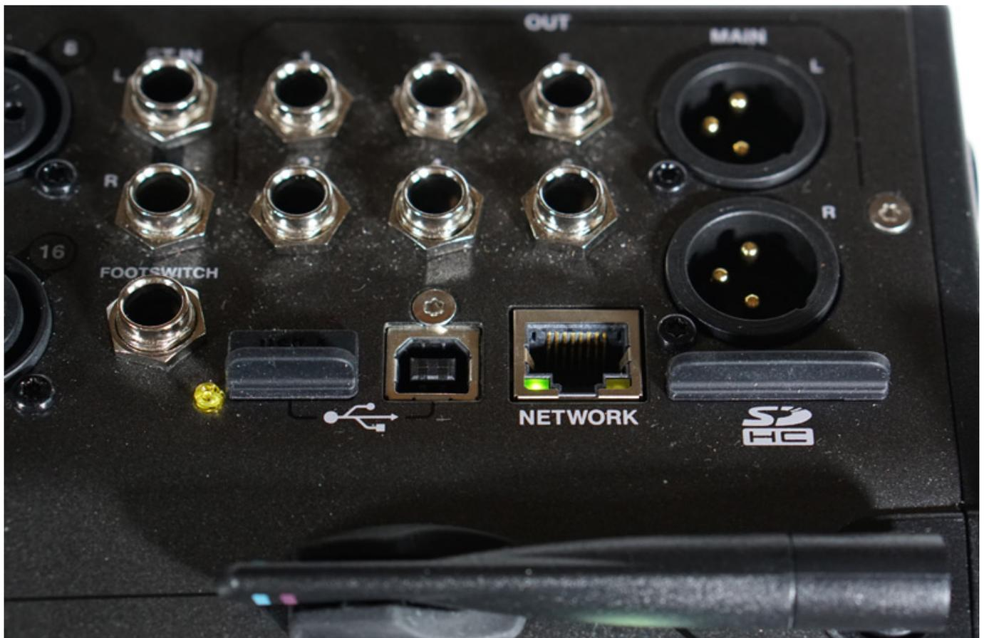
Auch ein WiFi Access Point, der mit 2,4 oder 5 GHz arbeitet, ist schon integriert. Abgerundet wird das Anschlussfeld durch eine Footswitch-Buchse, die sich frei belegen lässt. Die beiden Kopfhörer-Ausgänge haben rechts vorne an der Stirnseite Platz gefunden. Rückseitig findet sich der An-/Ausschalter und der Netzteilanschluss.
