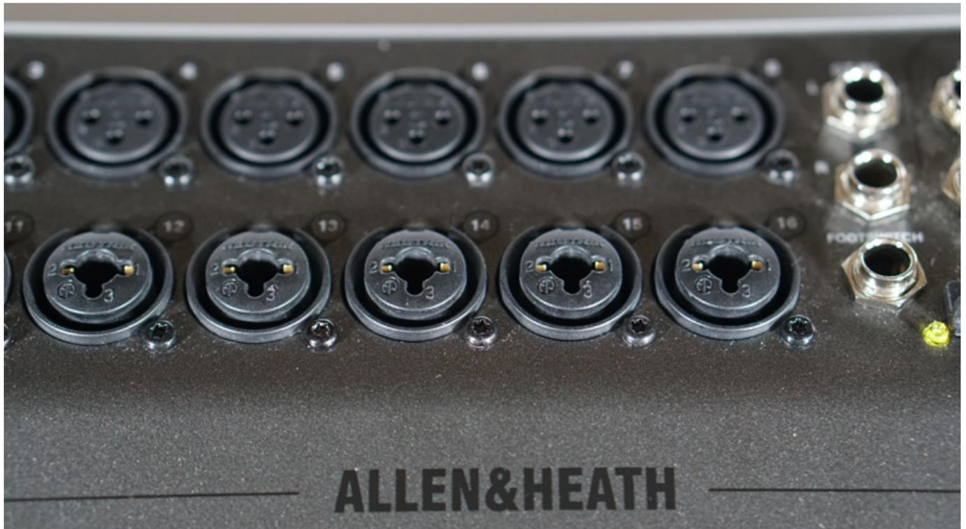
Jeweils zwei Eingänge können mit Link einen Stereokanal bilden. Kanal 17 und 18 sind als Stereokanal mit symmetrischen Klinken ausgelegt. Die Main-Outs sind als XLR-Buchsen ausgeführt, die restlichen sechs Ausgänge als symmetrische Klinkenbuchsen. Auch sie lassen sich paarweise als Stereoweg nutzen.
