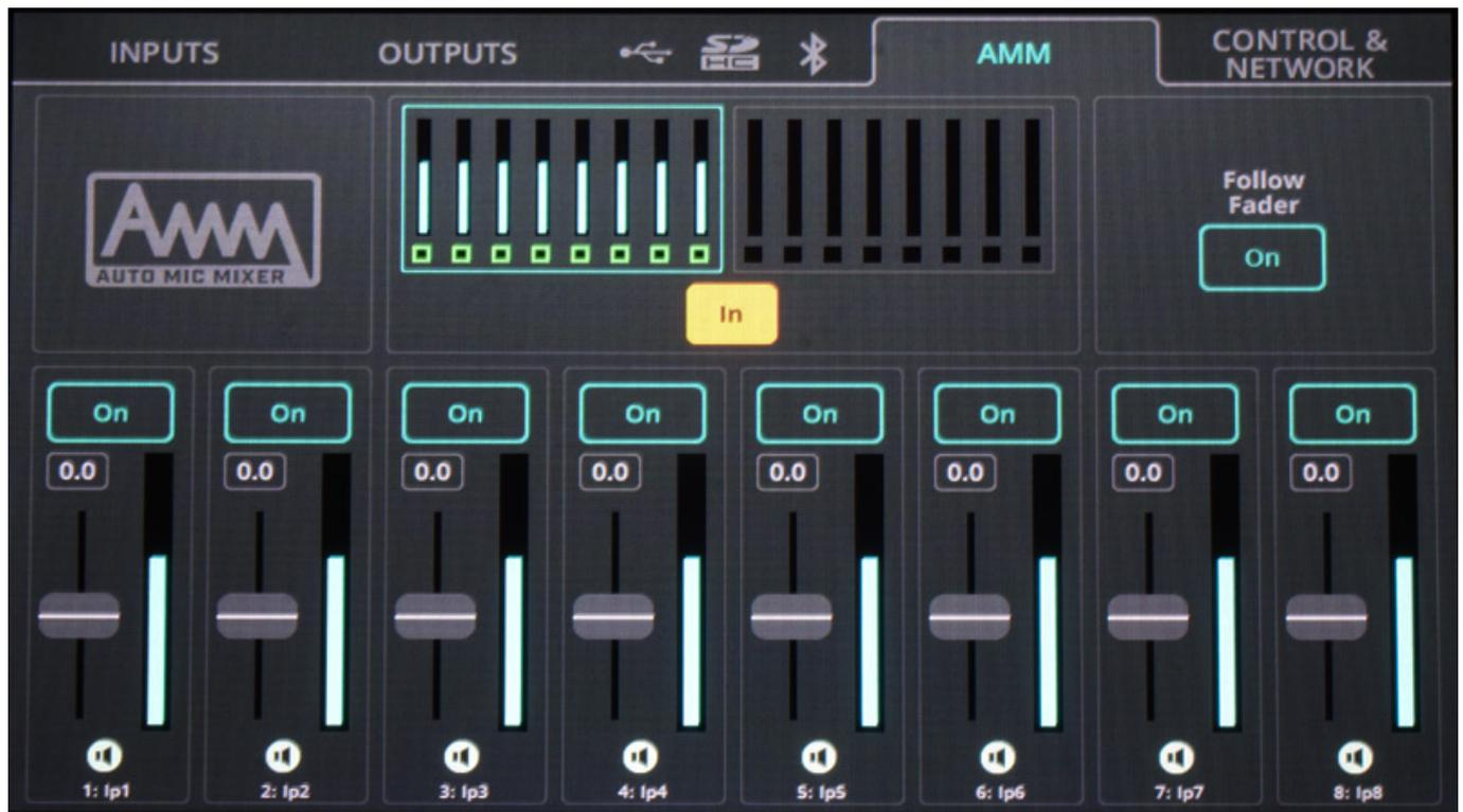
Jedes Eingangssignal lässt sich auf den Main-Out, zu den sechs Ausgangsbuchsen und zu den vier internen Effektblöcken routen. Anstatt mit analogen Signalen zu arbeiten kann jeder der 18 Kanäle auch separat auf digital umgestellt werden. Mit Bluetooth und USB-A erhöht sich die Anzahl der verfügbaren Eingangskanäle auf 22.
