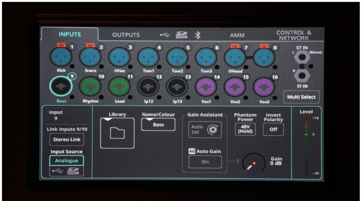
Stereo Link und Beschriftung lassen sich auch für die Ausgänge einstellen, auf der entsprechenden Seite werden Quelle und Lautstärke für die beiden Kopfhörer-Ausgänge eingestellt, die unabhängig agieren.
