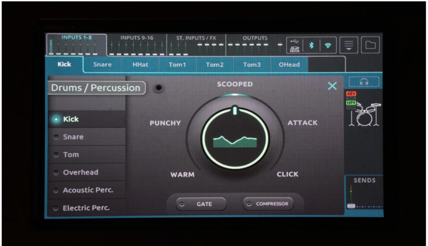
Einige Instrumente, wie Gitarre und Bass bieten eine Auswahl von sechs Voreinstellungen, die mit einer Dreiband-Klangregelung weiter angepasst werden können. Obwohl keine spezielle HiZ-Anpassung für Saiteninstrumente vorhanden ist, lassen sich hier auch über die Klinkeneingänge sehr brauchbare Sounds erzeugen.
