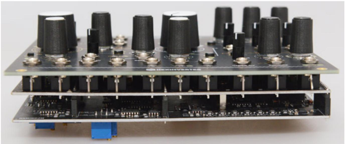
Technische Daten und Bedienung sind absolut identisch mit dem Originalmodul von Hexinverter. Die Stromaufnahme beträgt bei +12 Volt in der Spitze 190 mA und bei -12 Volt 115 mA. 5-Volt-Spannungsversorgung wird nicht benötigt.
