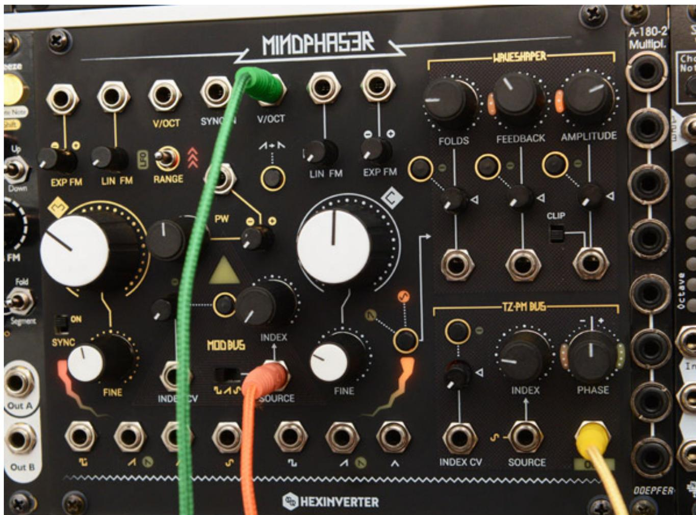
Der Mindphaser bietet extrem viele Einflussnahmen und Regelmöglichkeiten - auch über CV-Steuerung. Dank der Flexibilität lässt sich das Modul auch als zwei Einzeloszillator einsetzen - aber wer will das schon bei dem Klangpotential was das Complex Oscillator Konzept mit Träger- und Modulationsoszillator bietet.
