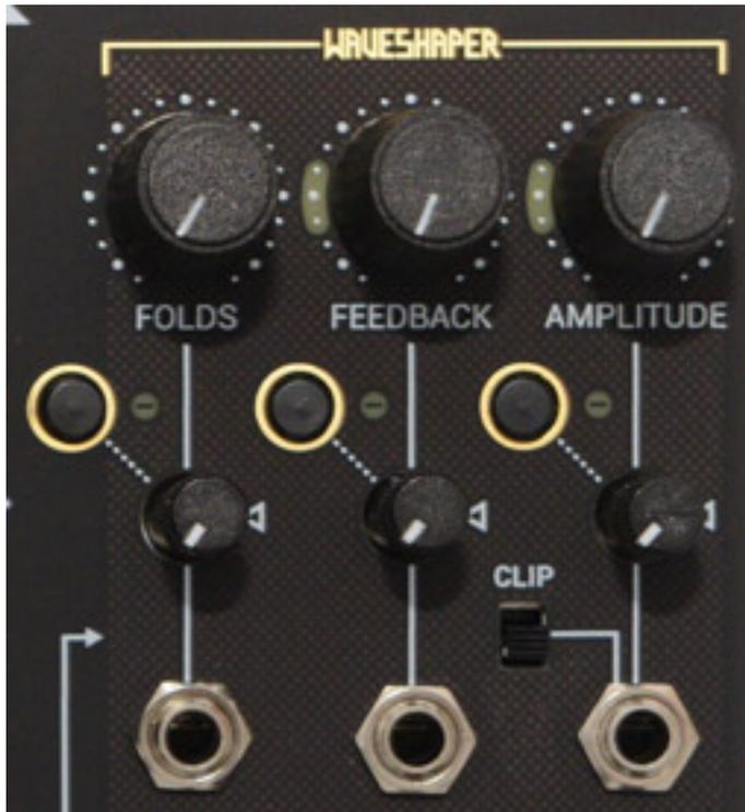
Über einen Taster neben den beiden Reglern für das Tuning lässt sich die Einstellen wie das Wavefolding erfolgen soll mit Dreieck- oder Sägezahn-Faltung. Das wird auch farblich über LEDs signalisiert. In der Waveshaper-Sektion lässt sich über den Regler AMPLITUDE der Waveshaper-Ausgangspegel beeinflussen, bzw. modulieren. Man hat im Wavefolder also bei Bedarf auch eine VCA-Funktion.
