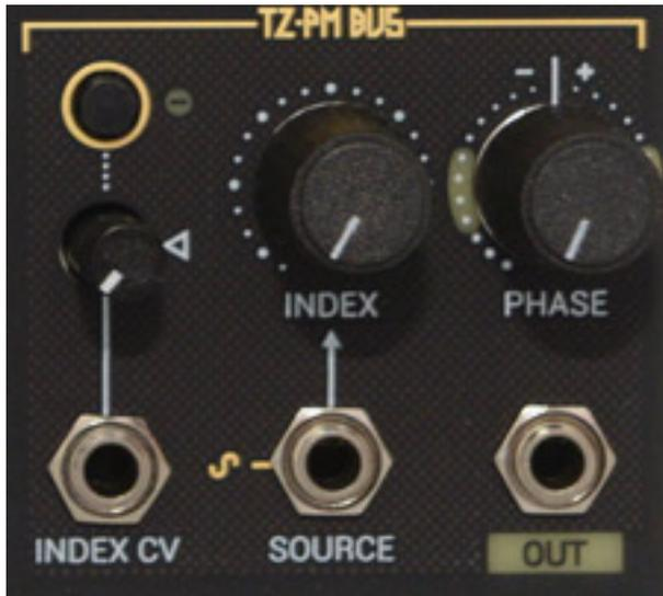
Der True-Zero Phase-Modulation-Bus ist eigentlich auch ein Teil des Wavefolders. Er verfügt auch über einen Index-Regler. Per default ist hier der Sinusausgang des Modulationsgenerators aufgeschaltet. Über eine Buchse kann der Anwender aber auch eine externe Signalquelle aufschalten. Auch hier lässt sich über einen CV-Eingang der TZ-PM-Modulationsgrad steuern. Die Buchse OUT stellt dann das Audio-Ausgangssignal bereit.
