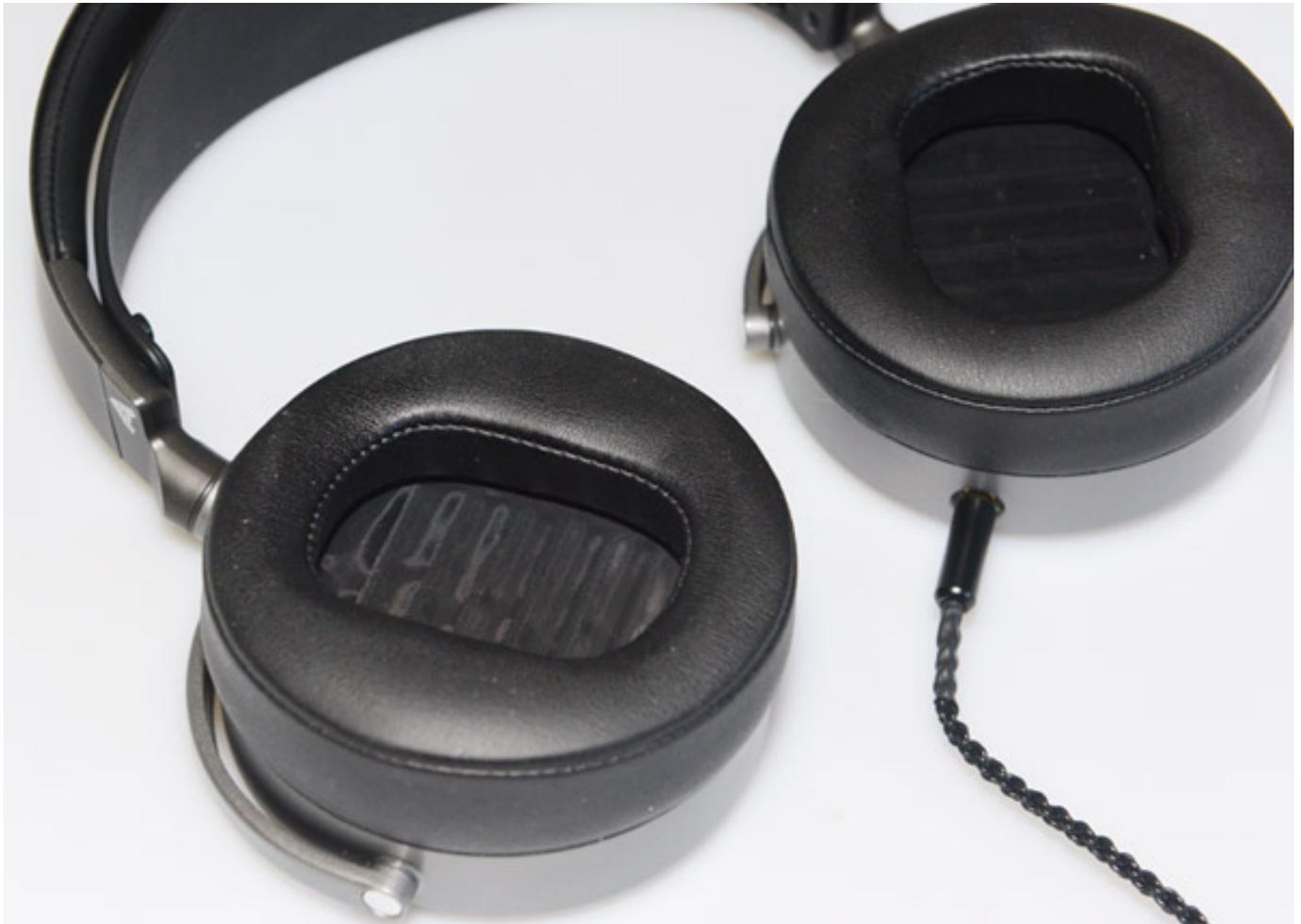
Für die Ohrpolster nutzt man beim MM-100 (s. oben) ein Gel während beim MM-500 sich ein elastisch-reversiblen Schaumstoff im Polster befindet. Die Polster beim MM-500 sind auch ein paar Millimeter höher.
