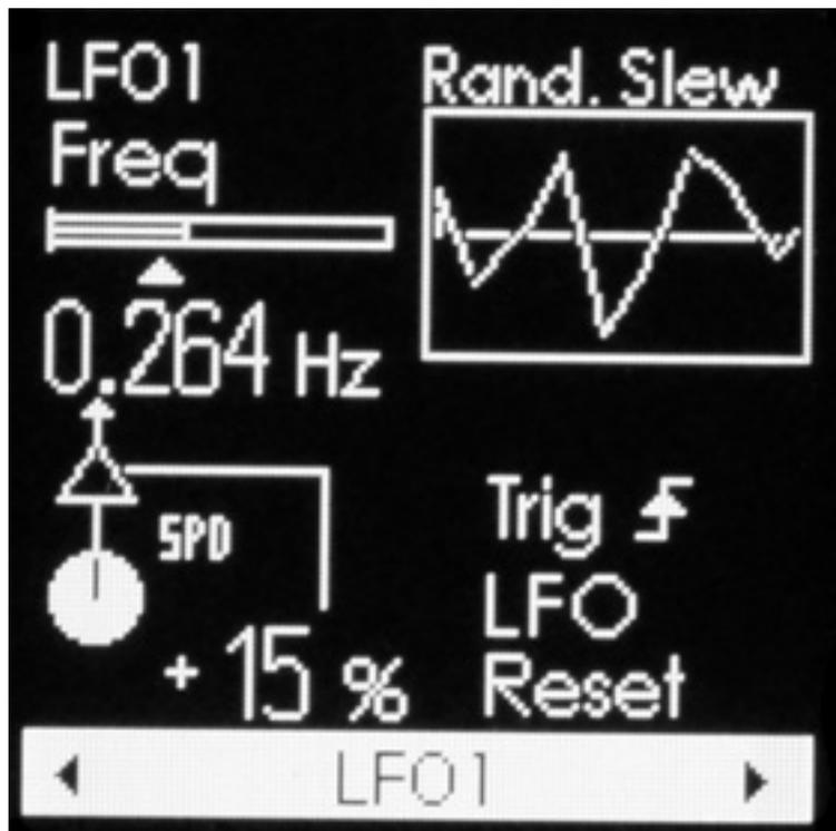
Die beiden verfügbaren LFOs lassen sich in Frequenz, Wellenform, bzw. Shape, Triggertyp und Einflussgrad des SPD-Potis auf die Frequenz einstellen. Es werden 22 verschiedene Wellenformen angeboten. Neben den üblichen wie Sinus, Cosinus, Dreieck und Zufallsgrößen gibt es auch verschiedene Ausschwingvorgänge. Diese Größen sind bipolar und entsprechen einer Modulationsspannung von +/-5 Volt. Daneben gibt es noch unipolare Shapes (entsprechen 0 ... 5 Volt) mit verschiedenen Rampenformen.
