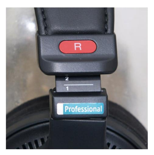
Der Bügel lässt sich bis auf jeder Seite um 40 mm ausziehen. Das reicht auch für größte Köpfe. Damit man seine gewünschte Einstellung schnell wiederfindet ist auch eine Skala auf dem Innenbügel aufgeprägt und Rechts und Links wird auch markant mit Buchstaben und Farben Rot und Blau gekennzeichnet. Das Gewicht des Kopfhörers beträgt 223 Gramm ohne Kabel.
