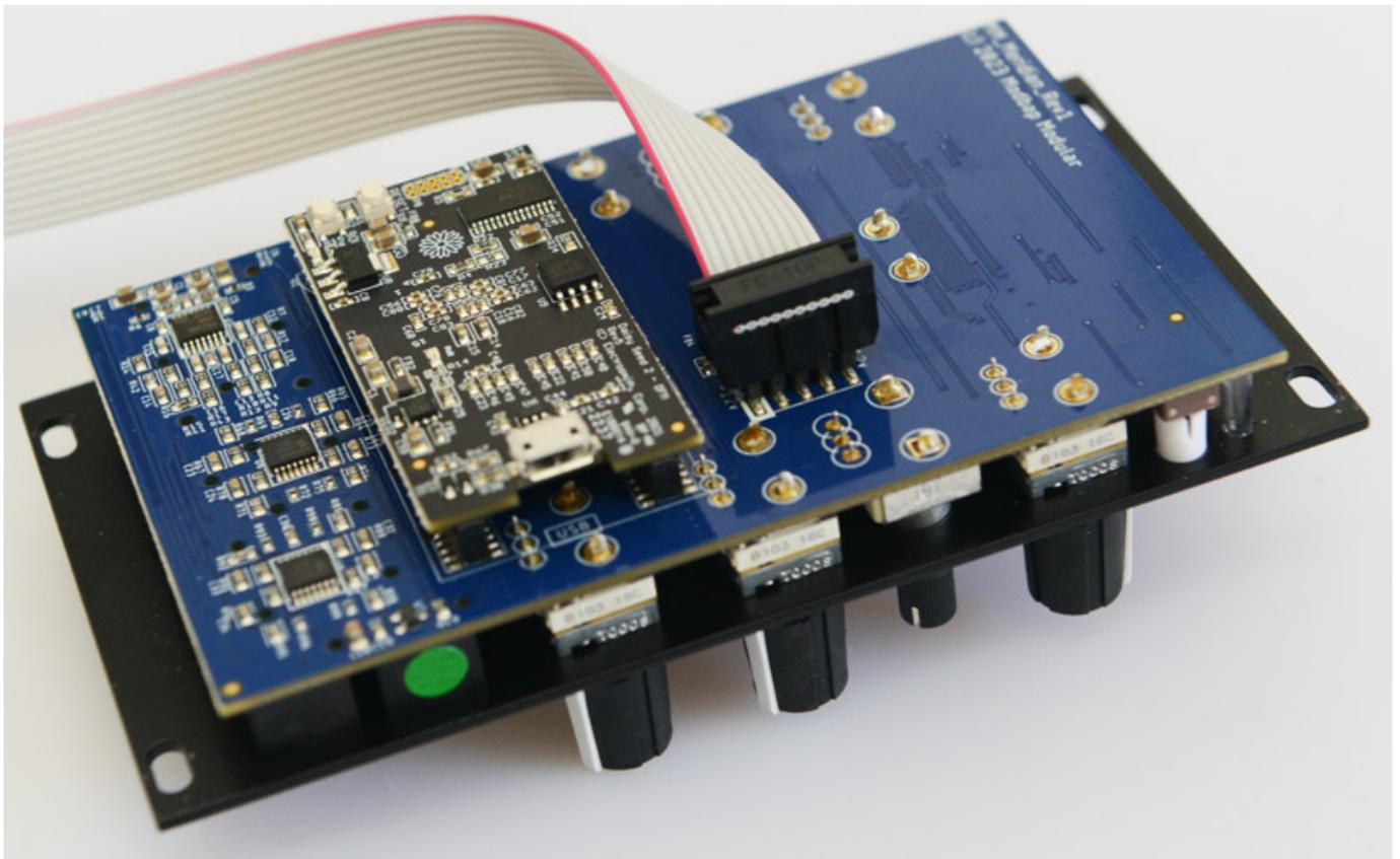
Die Bautiefe des Moduls beträgt 34 Millimeter. Damit passt es auch in viele Desktop-Skiff-Gehäuse. Die Stromaufnahme betrug bei unserem Testmodul in der Spitze 119 mA bei +12 Volt und 7 mA bei -12 Volt. Eine 5-Volt-Stromversorgung benötigt das Modul nicht.
