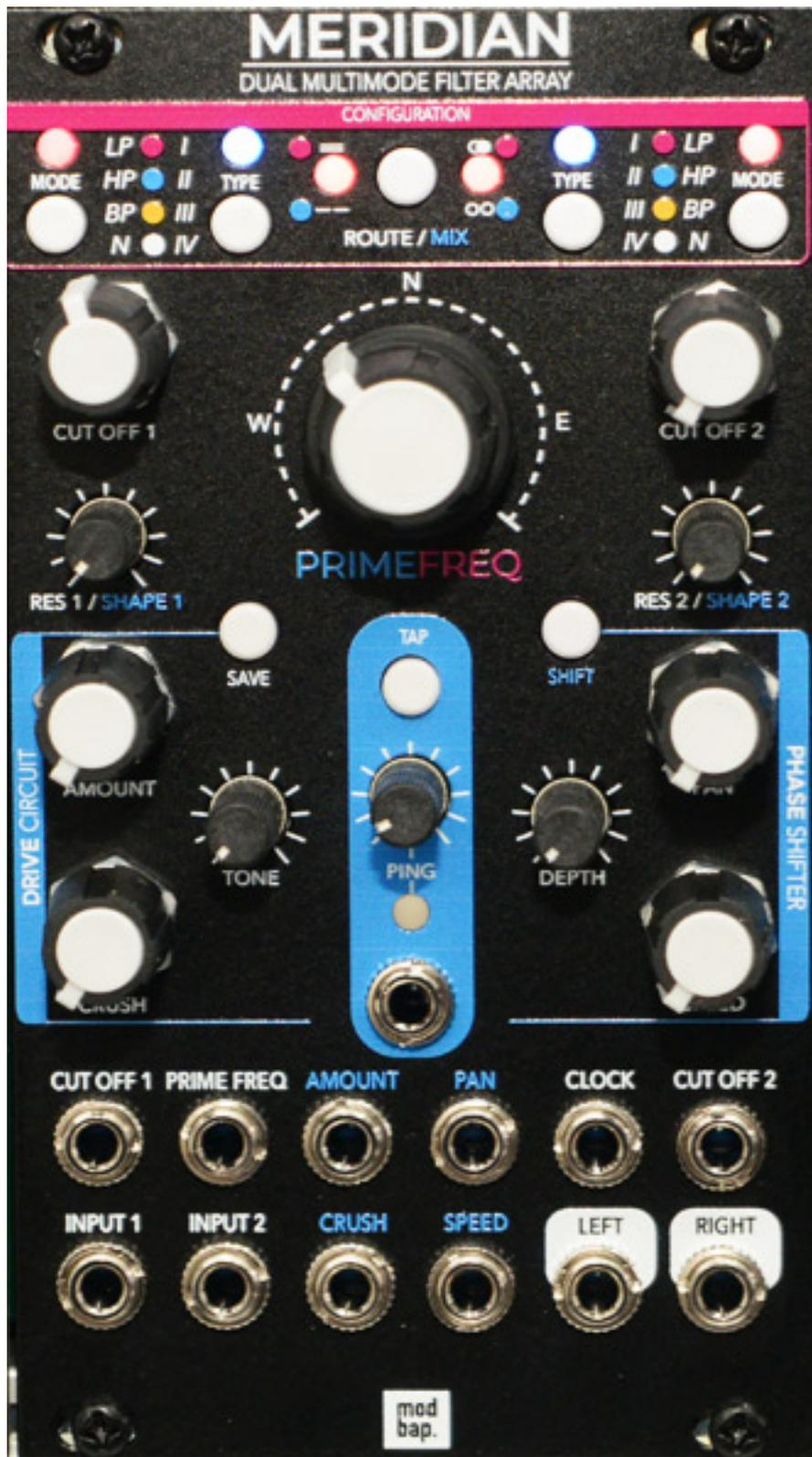
Das Modul teilt sich in vier Sektionen auf. Ganz oben die Tasten für die Einstellung der Filter-Modes, Filtertypen und des Routings. Darunter befindet sich einmal die Sektion für die Filterfrequenz und Resonanz, darunter die Effektsektion und ganz unten die zwölf Klinkenbuchsen mit den Ein- und Ausgängen.
