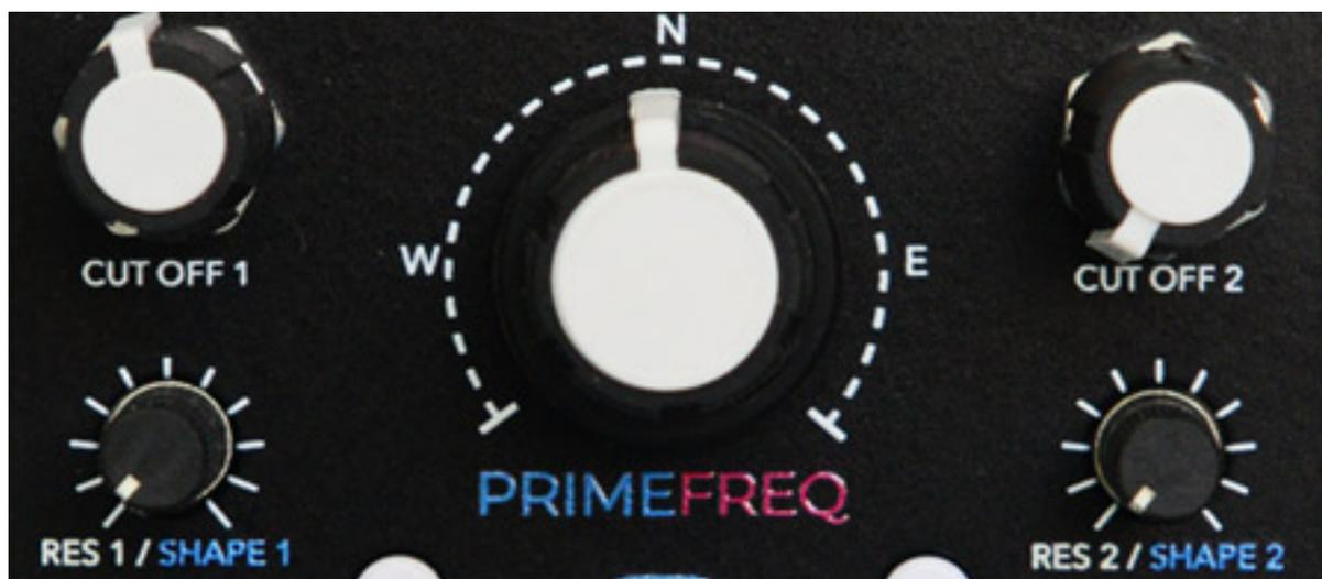
In der nächsten Sektion lässt sich die generelle (also für beide Filter) und die individuelle Filterfrequenz der einzelnen Filter über PRIME FREQU und CUT OFF 1/2 einstellen. Weiter gibt es für jedes Filter noch mit RES 1/2 individuelle Regler für die Filterresonanz (s. Abb. oben).
