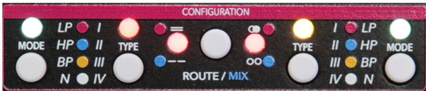
Kommen wir einmal zur grundsätzlichen Konfiguration des Moduls. Das Routing (Filter parallel oder seriell) sowie die Dual-Betriebsart (Stereo, Dual Mono) kann der Anwender über den Taster ROUTE und SHIFT plus ROUTE einstellen. Multi-Color-LEDs dienen hier als Statusanzeige (rot/blau).
