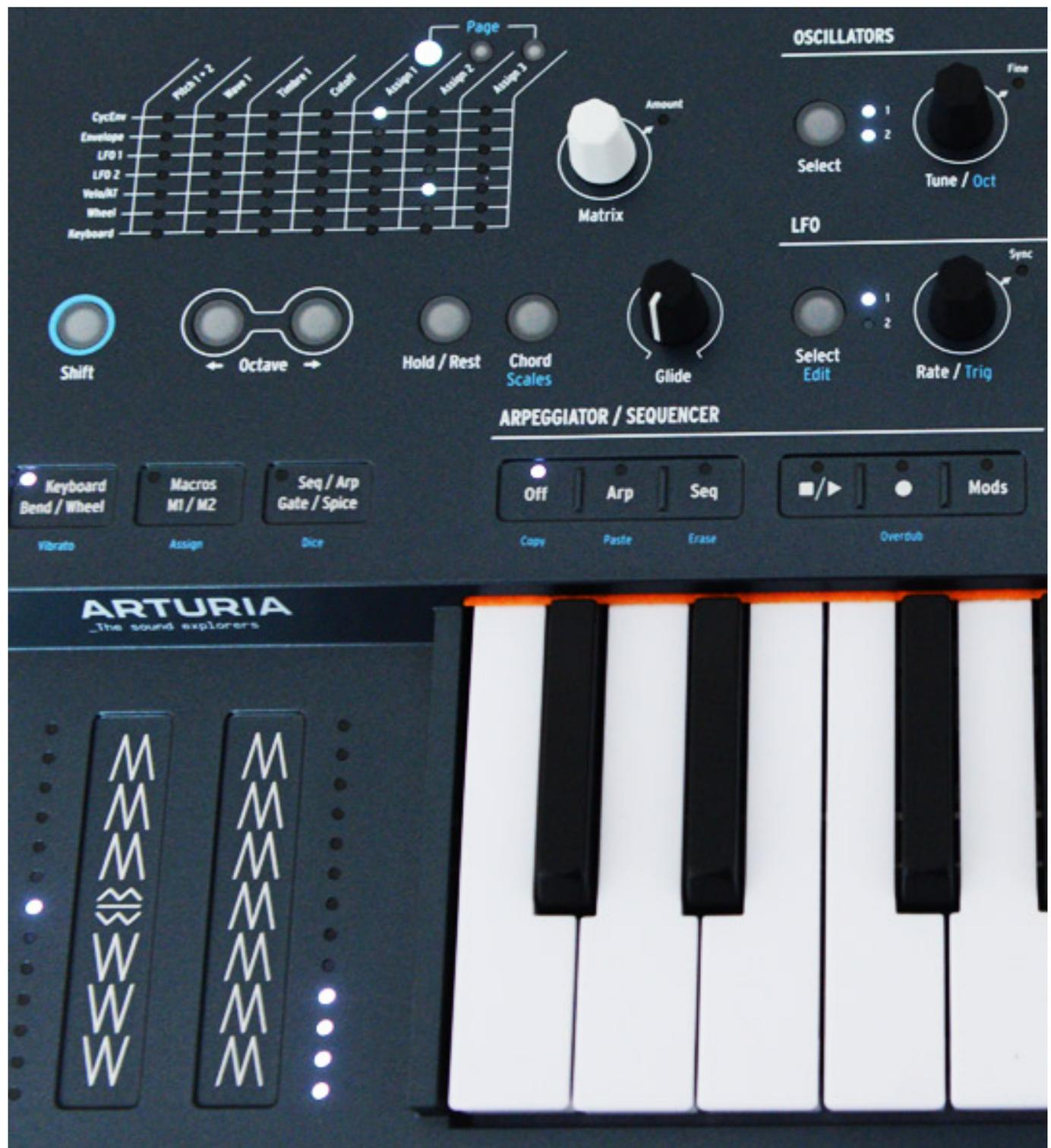
Der MiniFreak verfügt auch noch über zwei Touch Strips zur Kontrolle von Echtzeit-Modulation (s. Abb. oben). Neben den Tastern und Reglern gibt es noch einen Streifen über dem Keyboard mit insgesamt 30 kapazitiven Tasten mit LED-Indikatoren für Anwahl der Touch Strips-Funktionen sowie Arpeggiator- und Sequenzer-Funktionen.
