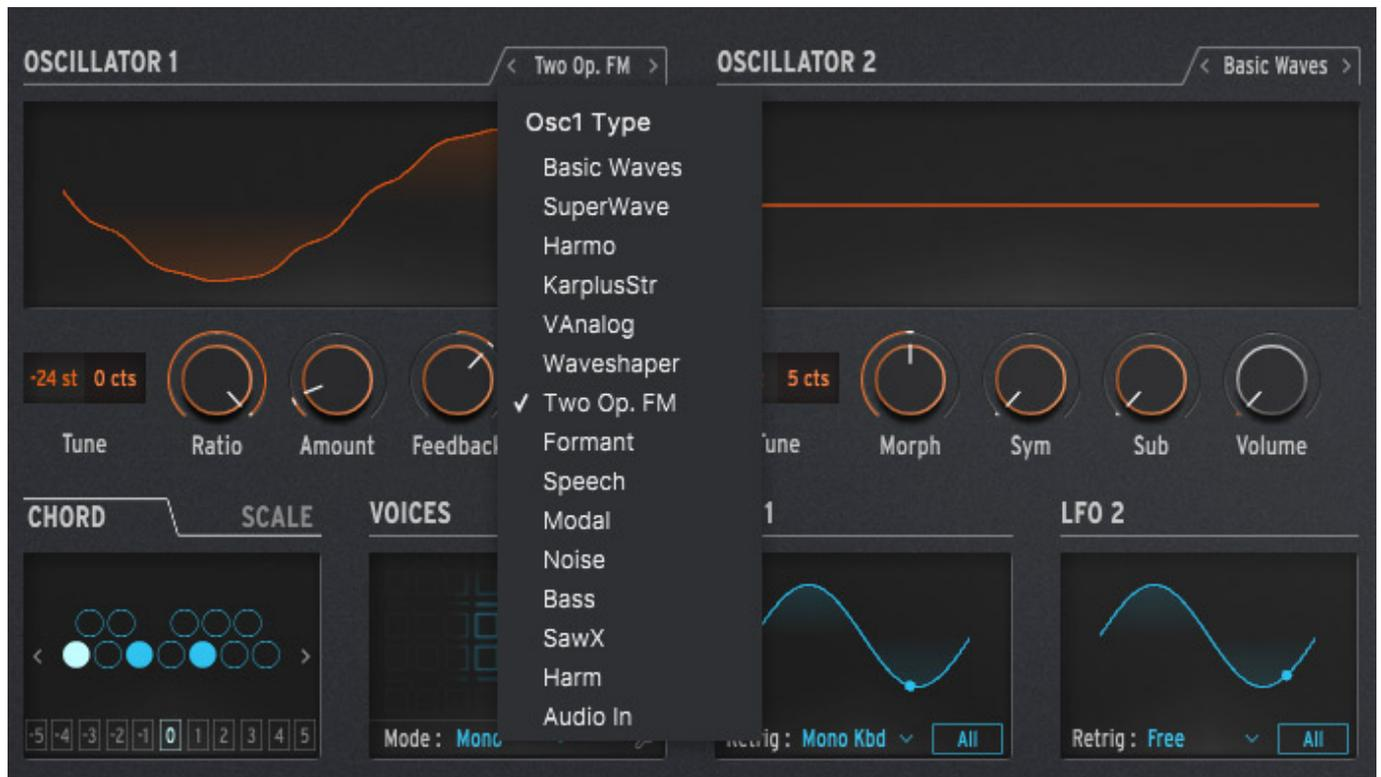
**Basic Wave** bietet zwei Wellenformen und zwar Rechteck und Sägezahn. Über den Parameter "Morph" kann man zwischen den Wellenformen hin- und herblenden und mit über den Regler "Symmetry" lässt sich die Pulsbreite, bzw. die Phasenverschiebung zwischen den Sägezahnwellen einstellen. Pber den Parameter "Sub" lässt sich auch ein eine Oktave tiefer gestimmten Sinus hinzumischen.
