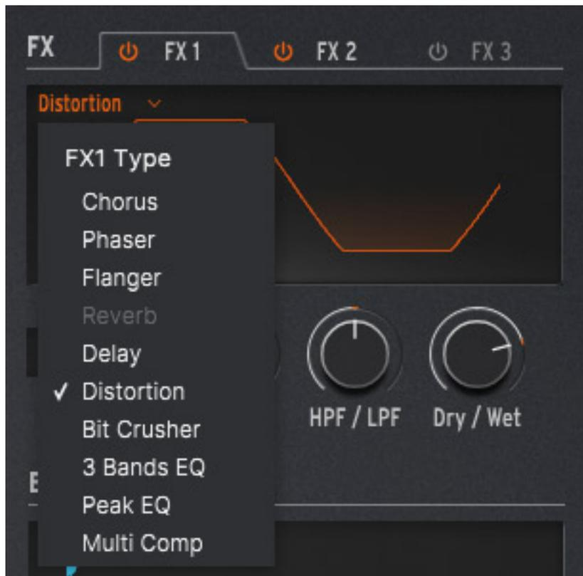
MiniFreak bietet drei in Serie geschaltete Effekt (s. Abb. oben), die sich einzeln aktivieren und deaktivieren lassen. Welche Effekte bereitstehen, bzw. angewählt sind sieht man in der obigen Abbildung. Bei Reverb stehen die Modes Default, Long, Hall, Echoes, Room und Dark Room zur Verfügung und bei dem Delay Digital, Stereo, Ping-Pong, Mono, Filtered, und Filtered Ping-Pong, jedes zudem ebenfalls in einer Sync-Version.
