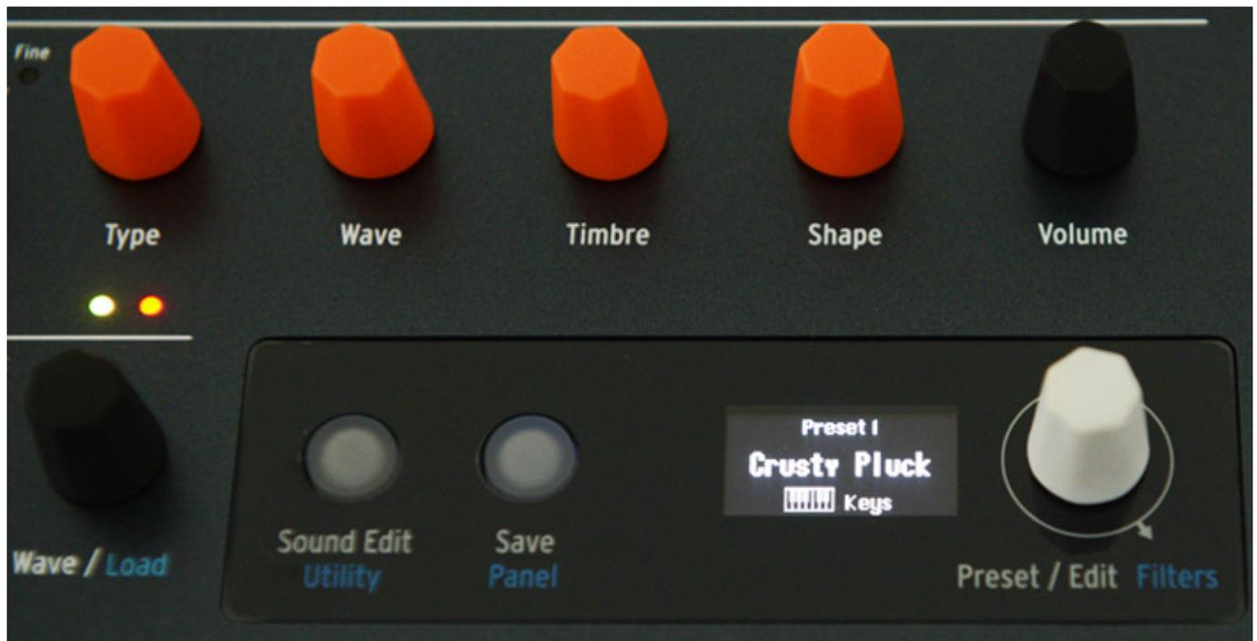
Am Hardware-Synth gibt es vier zentrale, orangene Regler, welche verschiedene Parameter der angewählten Engine verändern (s. Abb. oben) sowie ein Volume-Regler. Über Taster und einem Regler lassen sich Presets auswählen und speichern. Über ein kleines OLED-Display wird dann der Preset-Name angezeigt.
