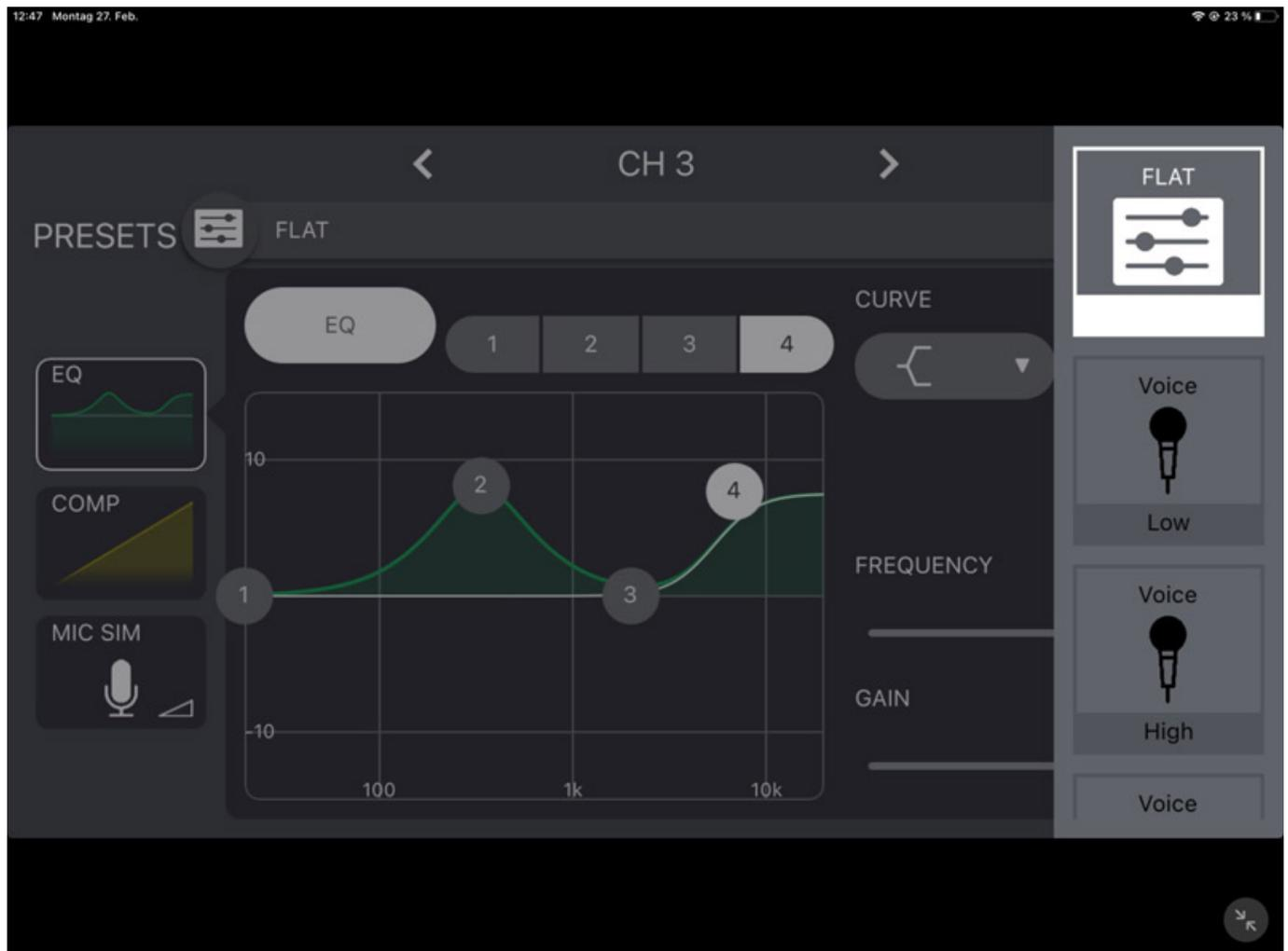
Unterschiedliche Presets wie „Flat“, „Voice Low“, „Voice High“, „Voice Chorus“, „Voice Narrator“, „A-Guitar Stroke“, „A-Guitar Arpeggio“, „E-Bass“ und „Percussion“ eröffnen angepasste Voreinstellungen von Equalizer und Kompressor – wohlgemerkt pro Kanal. Auf der Mix-Hauptseite lässt sich der Feedback-Controller zuschalten, begleitet von einem Sechsband-Equalizer mit variablem Q-Faktor und definierbaren Einsatzfrequenzen.
