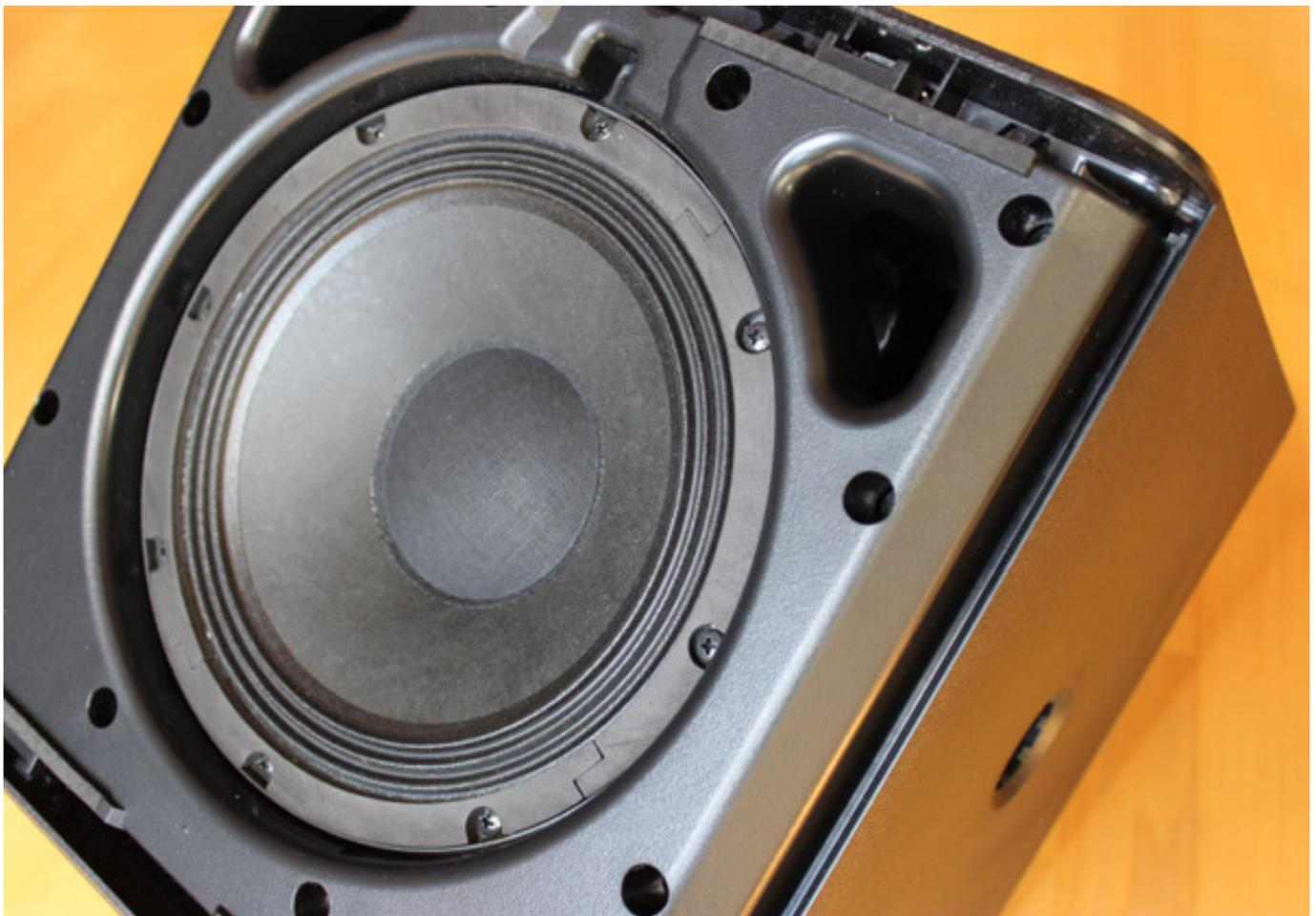
In den technischen Daten wird der Frequenzumfang (@ -10 dB) vom Hersteller mit 60 Hz bis 20 kHz angegeben. Auf Basis von IEC-Rauschen als Testsignal, dabei handelt es sich um modifiziertes Rosa Rauschen, beträgt der maximale Schalldruckpegel 125 dB SPL (@ 1 m). Dieser Wert lässt sich allerdings nur bei minimaler Lastimpedanz und ohne Schutzschaltung erreichen (siehe Messungen). Das integrierte Digitalmischpult (24 Bit/48 kHz) mit drei Monokanälen und einem
