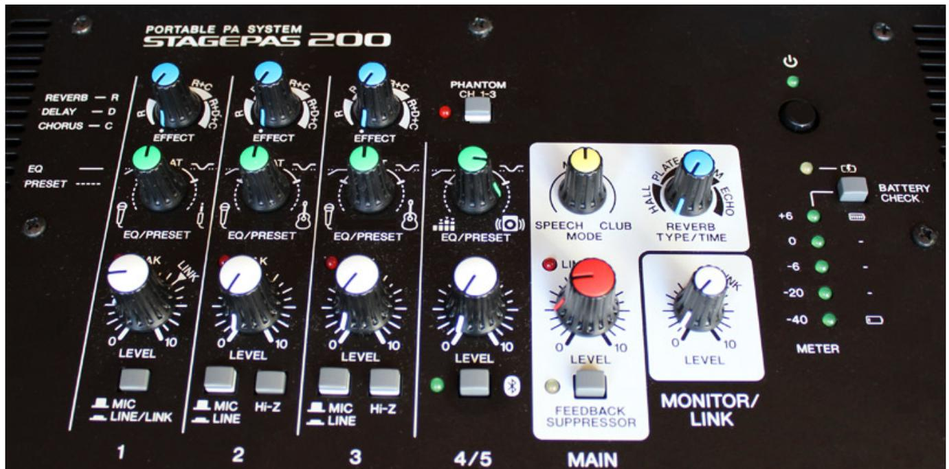
Als Eingänge stehen ein Stereo-Input für externe Zuspeler, kabelgebunden oder Bluetooth, sowie drei Mono-Kanäle bereit, die sich mit dem One-Knob-Equalizer von Yamaha den persönlichen Klangvorstellungen anpassen lassen. Die drei Monokanäle sind per Taster für Mic/Line-Signale schaltbar. Auch an Hi-Z-Instrumente wurde gedacht: Kanal 2 und 3 bieten entsprechende Taster.
