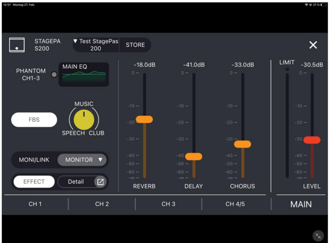
Ähnlich grafikorientiert funktioniert auch der Mode-Regler. Mit diesem Regler sind EQ-Voreinstellungen für den Mix wählbar. Die Mittelstellung (MUSIC) dient als Grundeinstellung. Wird der Regler gegen den Uhrzeigersinn (Richtung SPEECH) gedreht, werden nicht benötigte Bassfrequenzen abgesenkt, um eine optimale
