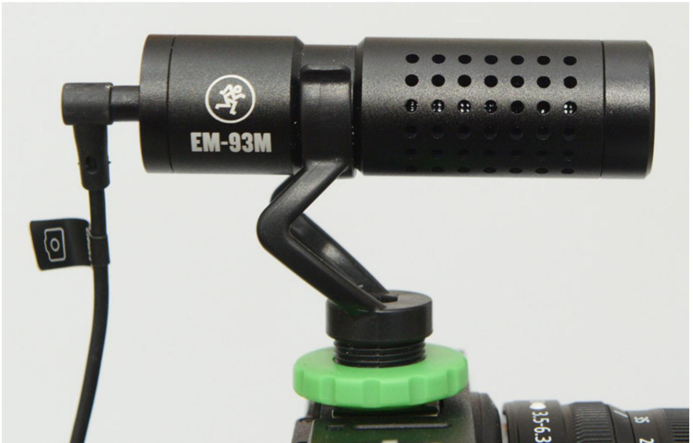
Werfen wir zunächst einmal einen Blick auf das kompakte (79 x 23 mm) EM-93M, ein leichtes Kleinmembran-Kondensatormikrofon mit Nieren-Richtcharakteristik (s. Abb. oben), welches sich über eine mitgelieferte Halterung auf den Kamera-Blitzschuh montieren lässt. Das Gewicht beträgt ca. 40 Gramm. Die Halterung dient auch gleich als Körperschallentkopplung.
