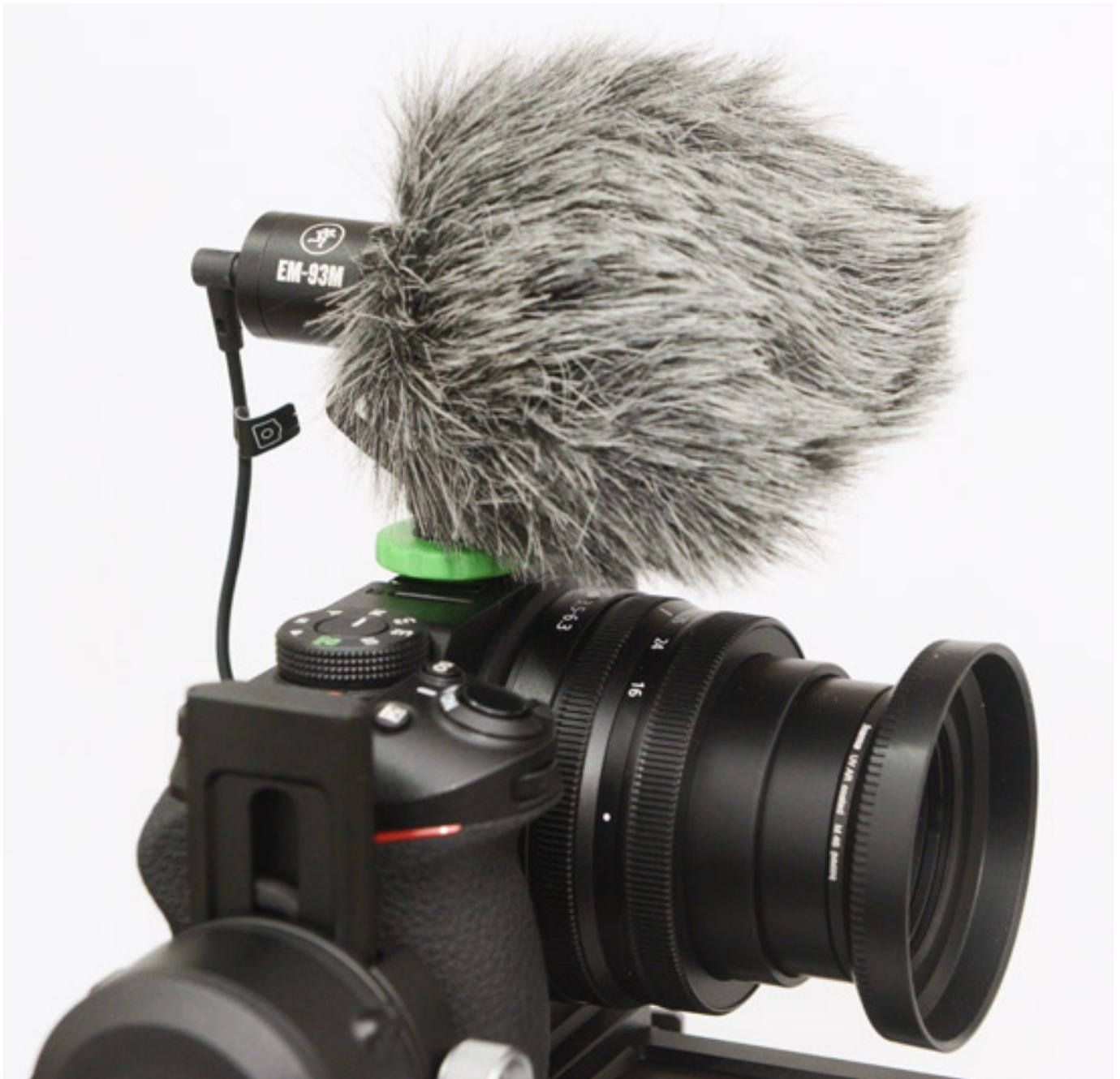
Kommen wir zunächst zum EM-93M. Das Mikrofon ist mit seinen beiden Windschützen und beiliegenden Kabeln gut ausgestattet. Es hinterlässt einen soliden mechanischen Eindruck. Sound-mäßig bietet das EM-93M einen großen Übertragungsbereich - auch im Bassbereich. Da muss man ggf. ein Hochpaß in der Kamera im Außeneinsatz zuschalten. Von der Klangabstimmung ist das Mikrofon aber wirklich überzeugend, auch gegen teurere Mitbewerber.
