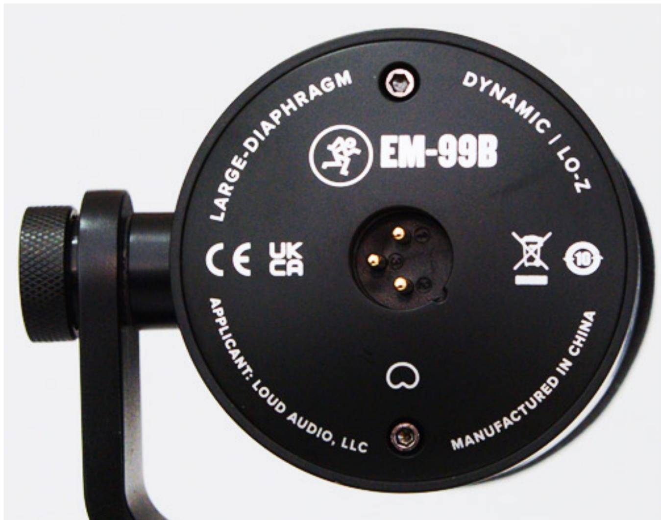
Das Mikrofon ist ein klassisches Mikrofon mit dynamischen Wandler ohne aktive Elektronik und bedarf daher keiner Phantomspeisespannung. Die Ausgangs-Symmetrierung erfolgt über Abgriffe der Tauchspule. Der Hersteller gibt die Impedanz mit 350 Ohm und die Empfindlichkeit mit -53 dB (bezogen auf 1V/Pa) an, also ein Übertragungsfaktor von ca. 2,2 mV/Pa. Der Signalstörabstand beträgt 82 dB (A) und der Dynamikumfang wird vom Hersteller mit 145 dB angegeben.
