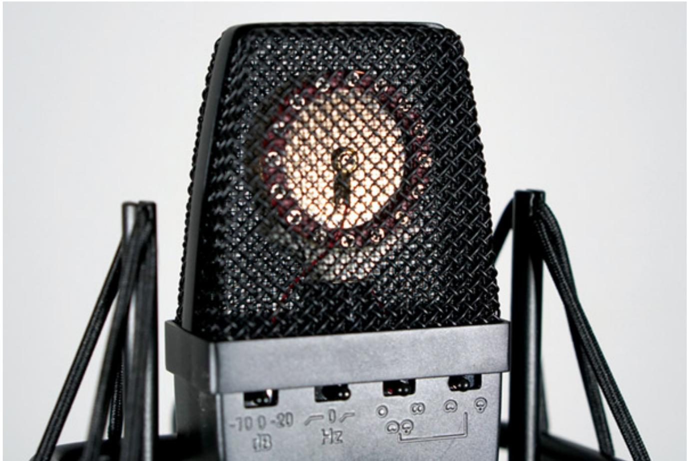
Grundsätzlich sind beide Mikrofone gleich aufgebaut und der Unterschied liegt in der Beschichtung der Mylar-Membran. Während das sE4400 hier auf die klassische Goldbedampfung setzt, kommt beim T2 das härtere und leichtere Titan zum Einsatz. Das soll das Ansprechen der Kapsel verbessern und für präzisere, schnellere Transienten sorgen.
