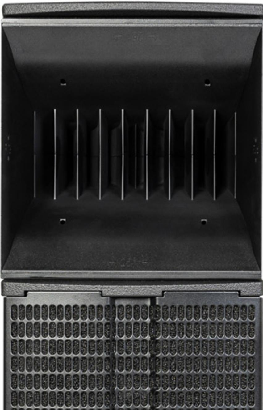
Kombiniert man mehrere Linear 9 210 LTA pro Seite, so muss man die MCT-Hörner um 90 Grad drehen. Mit Hilfe des mitgelieferten Werkzeugs ist das schnell erledigt. Somit erweist sich das Topteil als erfreulich skalierbar. Der verbaute 1.4"-Ferrit-Hochtöner wird bei 1,35 kHz von den beiden 10" getrennt.
