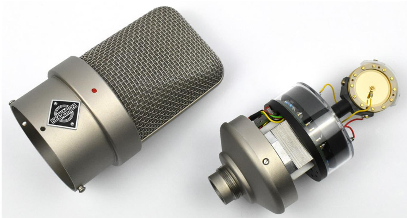
Es erübrigt sich vermutlich es überhaupt zu erwähnen, aber für alle, die mit dem M 49 noch gar nicht vertraut sind: Es handelt sich um ein Großmembran-Kondensatormikrofon mit stufenlos einstellbarer Richtcharakteristik. Die Pattern-Auswahl erfolgt über einen Regler am Netzgerät, und ist somit vom Toningenieur fernsteuerbar. Anfang der 1950er Jahre war diese Funktion ein absolutes Novum. Viele nachfolgende Röhrenmikrofone bauen auf dieser Errungenschaft von Neumann auf.
