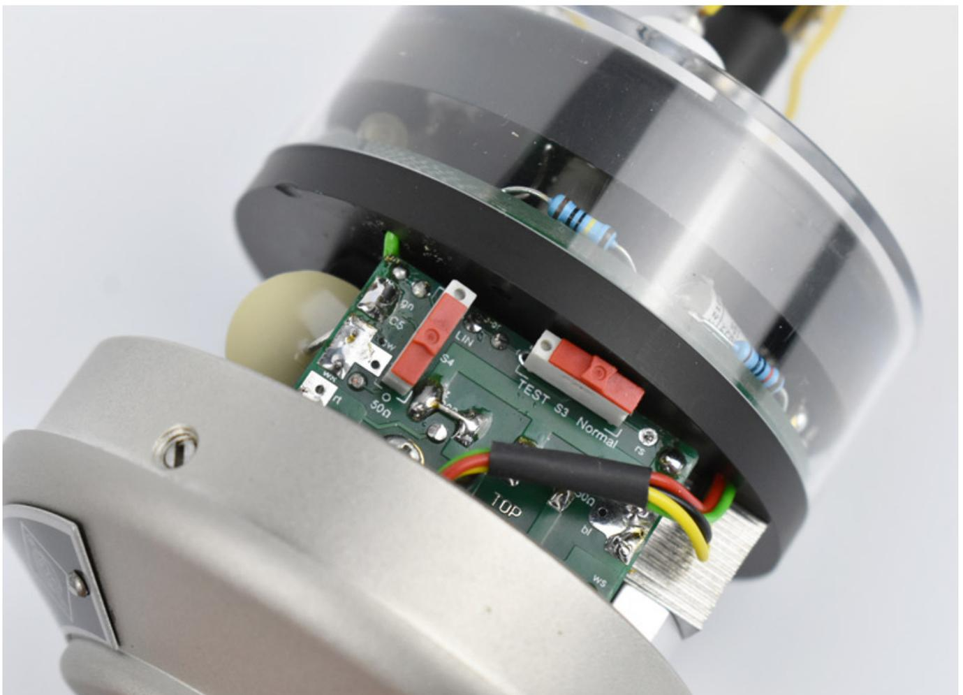
Einfacher zu erreichen ist der Schalter S4 (s. Abb. oben), der das bereits angesprochene Hochpass-Filter deaktiviert. Dieser sitzt auf einer leicht
